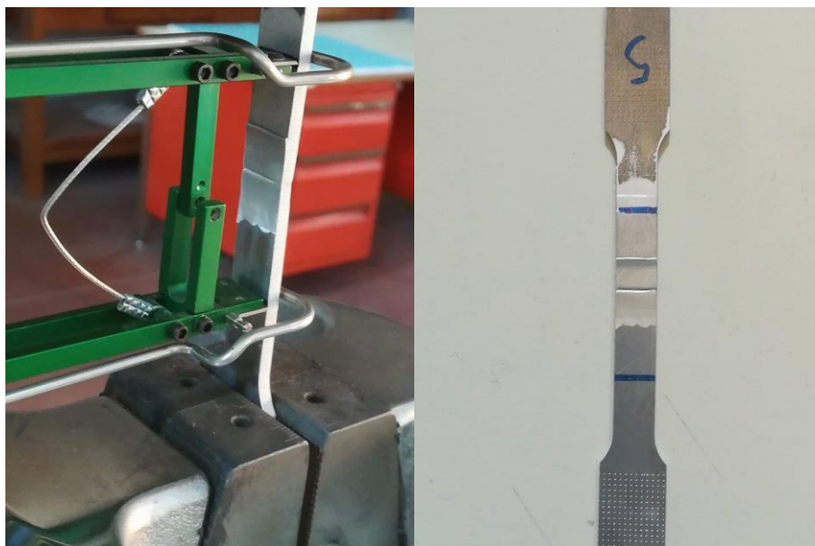
Εικόνα 130: Απεικόνιση θραυσμένου δοκιμίου έπειτα από ηλεκτροχημική διέγερση σε περιβάλλον υδρογόνου για συνθήκες καθοδικής πόλωσης ( 80 \text{ mA/cm}^2 , 4 ώρες)
