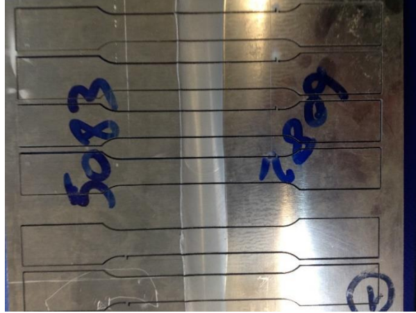
Εικόνα 118: Κοπή συγκολλημένης πλάκας κάθετα στον άξονα της ραφής ώστε να εξαχθούν δοκίμια εφελκυσμού που να περιλαμβάνουν όλες τις περιοχές της συγκόλλησης
