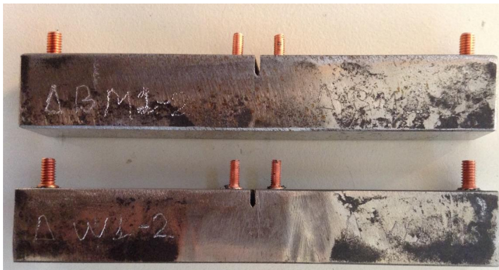
Εικόνα 193: Αποτύπωση της γεωμετρίας των δοκιμών τα οποία υπεβλήθησαν σε μηχανική καταπόνηση CTOD
