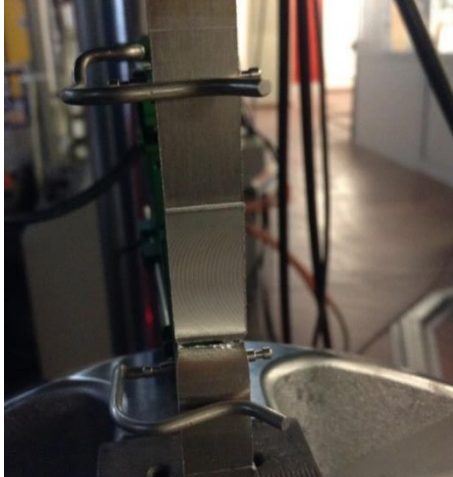
Εικόνα 125: Απεικόνιση του θραυσμένου δοκιμίου έπειτα από δοκιμή εφελκυσμού χωρίς προγενέστερη ηλεκτροχημική διέγερση σε πεδίο καθοδικής πόλωσης.
