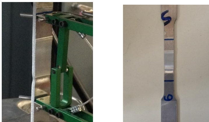
Εικόνα 126: Απεικόνιση θραυσμένου δοκιμίου έπειτα από ηλεκτροχημική διέγερση σε περιβάλλον υδρογόνου για συνθήκες καθοδικής πόλωσης ( 20 \text{ mA/cm}^2 , 4 ώρες)
