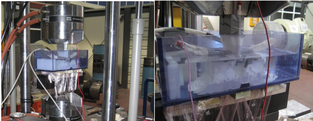
Εικόνα 254: Φωτογραφική απεικόνιση της κυψέλης όπου πραγματοποιήθηκε η ηλεκτροχημική διέγερση, του τροφοδοτικού το οποίο λειτούργησε ως γαλβανοστάτης (σταθεροποίηση της πυκνότητας έντασης ρεύματος) και του ψηφιακού πολυμέτρου μέσω του οποίου μετρήθηκε η μεταβολή του πεδίου της ηλεκτρικής τάσης
