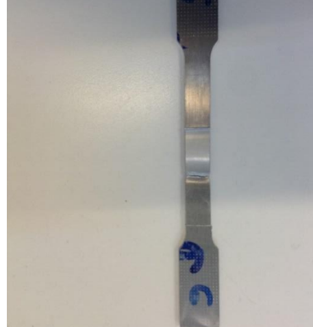
Εικόνα 125: Απεικόνιση του θραυσμένου δοκιμίου έπειτα από δοκιμή εφελκυσμού χωρίς προγενέστερη ηλεκτροχημική διέγερση σε πεδίο καθοδικής πόλωσης.
