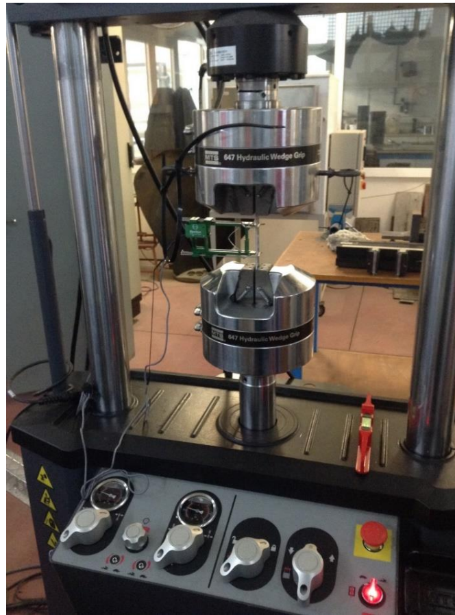
Εικόνα 116: Υδραυλική μηχανή δοκιμών όπου πραγματοποιήθηκε η εφελκυστική φόρτιση χαμηλού ρυθμού παραμόρφωσης έπειτα από την καθοδική πόλωση των συγκολλημένων δοκιμών
