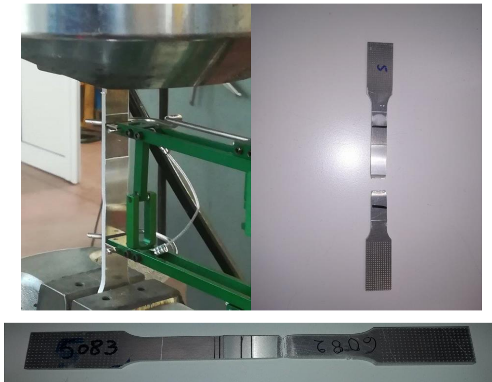
Εικόνα 129: Απεικόνιση θραυσμένου δοκιμίου έπειτα από ηλεκτροχημική διέγερση σε περιβάλλον υδρογόνου για συνθήκες καθοδικής πόλωσης ( 80 \text{ mA/cm}^2 , 2 ώρες)
