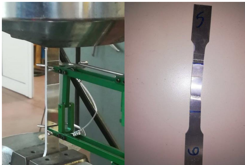
Εικόνα 128: Απεικόνιση θραυσμένου δοκιμίου έπειτα από ηλεκτροχημική διέγερση σε περιβάλλον υδρογόνου για συνθήκες καθοδικής πόλωσης ( 50 \text{ mA/cm}^2 , 4 ώρες)
