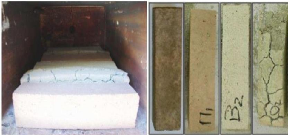
Εικόνα 2.1: Δείγματα γεωπολυμερούς και OPC ύστερα από θερμική καταπόνηση τους 900 βαθμούς Κελσίου για 2 ώρες
