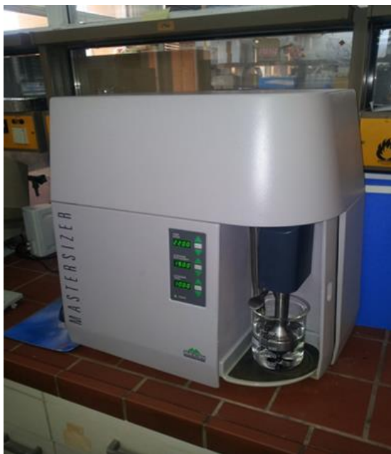
Εικόνα 4.4: Συσκευή τεχνολογίας περίθλασης ακτινών laser
