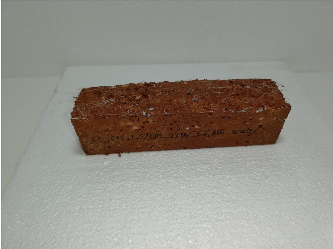
Εικόνα 5.4: Δείγμα γεωπολυμερούς ενισχυμένο με 1.5% κ.β. EPS, 2% κ.ο. ΡΕ και 6.0% κ.β. ανακυκλωμένα αδρανή
