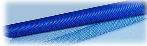
Εικόνα 14α (prepeg ινών βόριου υπό μορφή ταινίας) Εικόνα 14β (prepeg πλέγμα ινών γυαλιού)
