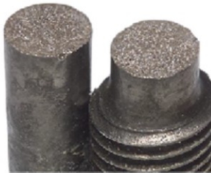
Εικόνα 11 Ψαθυρή θραύση σε Χάλυβα μέτριας περιεκτικότητας σε άνθρακα
