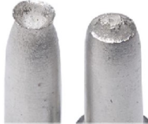
Εικόνα 10 Θραύση τύπου κυπέλλου - κώνου σε Αλουμίνιο
