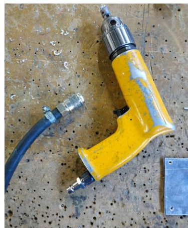
Εικόνα 36 Πιστόλι Αέρος για τη Δημιουργία Οπών
