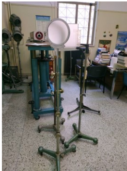
Εικόνα 39 (α) Συγκλίνων οπτικός φακός (β) Πηγή Φωτός-Laser με Ειδικό Φίλτρο (γ) Πέτασμα Αναφοράς
