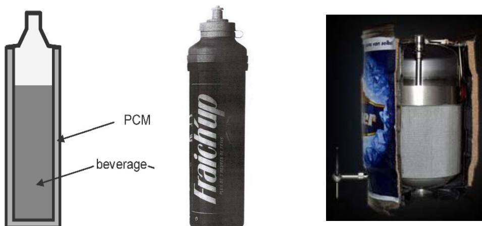
Σχήμα 3.29: (α) Γενική ιδέα ισοθερμικού μπουκαλιού [52] (β) Ισοθερμικό μπουκάλι νερού από την εταιρεία Sofrigam (γ) CoolKeg®, by Cool-System Bev. GmbH [51].
