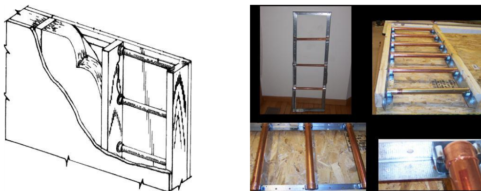
Σχήμα 4.17: Αριστερά: Σχηματική αναπαράσταση του πλαισίου αλλαγής φάσης του τοίχου, Δεξιά: Πλαίσιο ελαφρού μετάλλου "τύπου σκάλας" που κρατά τους σωλήνες PCM για PCFWs και λεπτομέρειες [32].
