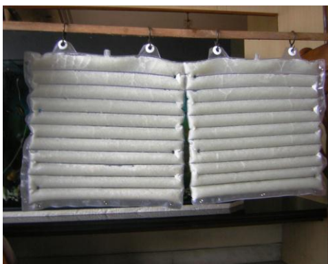
Σχήμα 3.11: Jacket μπαταρίας για εξωτερικό καταφύγιο τηλεπικοινωνιών [23].
