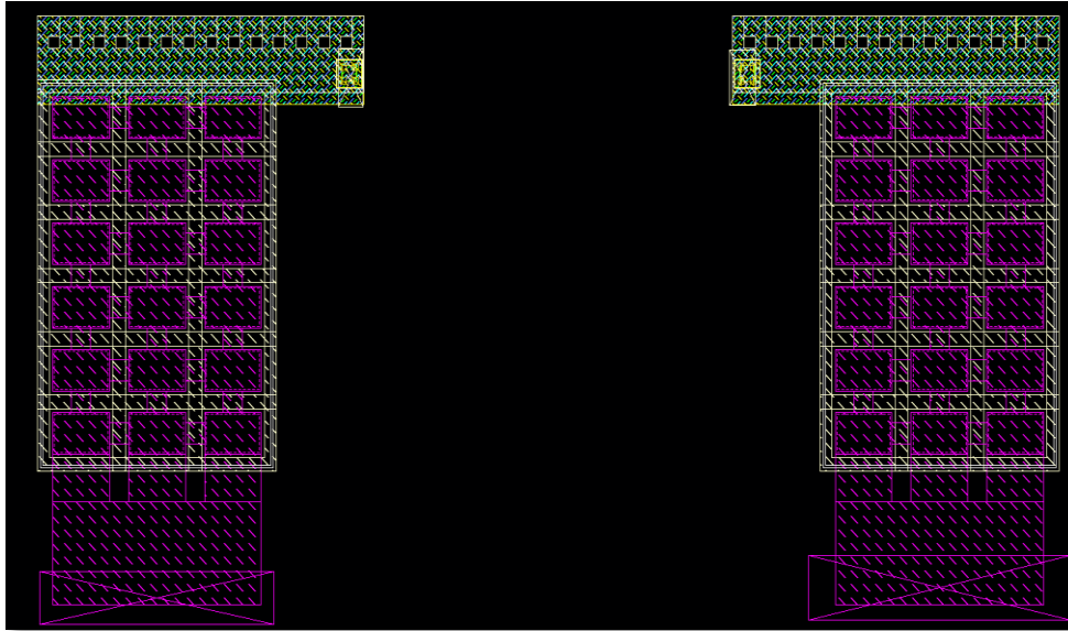
Σχήμα 5.4 Layout του πυκνωτή C_1 .
