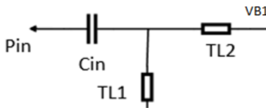
Σχήμα 4.22 Σχηματικό επιλεγμένου κυκλώματος εισόδου.
