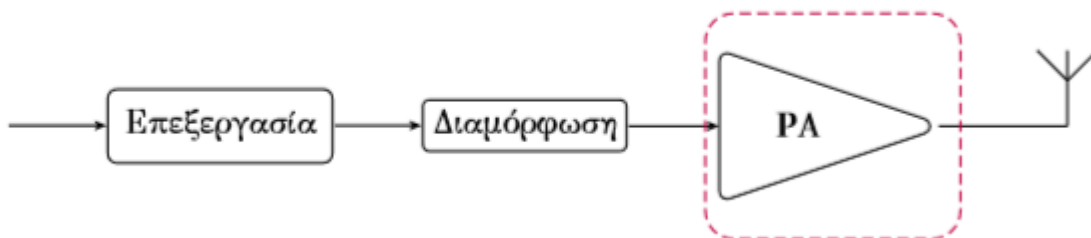
Σχήμα 1.3 Δομικό διάγραμμα πομπού (βλ. [6]).
