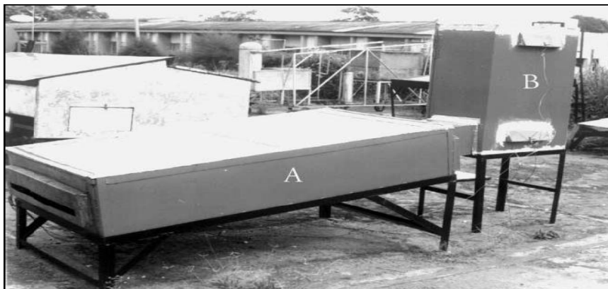
Σχήμα 4.5: Φωτογραφία ενός ηλιακού θερμοσίφωνα αέρα, όπου Α:συνδεσμολογία του συλλέκτη με την ενεργειακή αποθήκευση και τα υποσυστήματα θέρμανσης αέρα και Β:θερμαινόμενος χώρος[6].
