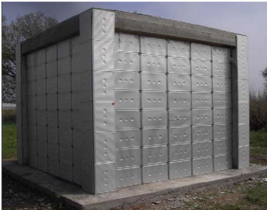
Σχήμα 5.11 : Θάλαμος από τούβλο με RT27 και πολυουρεθάνη[11].
