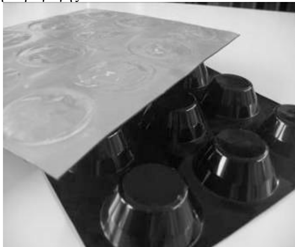
Εικόνα 8: Παραδείγματα ενσωμάτωσης PCM σε λωρίδες κάψουλων macroencapsulation
