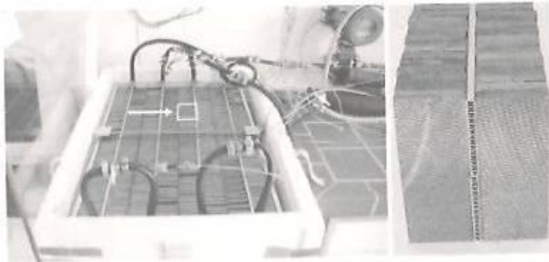
Εικόνα 1: Μοντέλο αποθήκευσης θερμότητας με μεταφορά ενέργειας μεταξύ του στοιχείου του όγκου του υλικού, που υποδεικνύεται από το βέλος, και ενός επίπεδου εναλλάκτη θερμότητας
