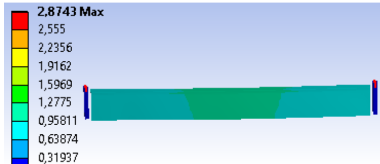
Εικόνα 4-2: Μέγιστο βέλος 1 ου στάδιου
