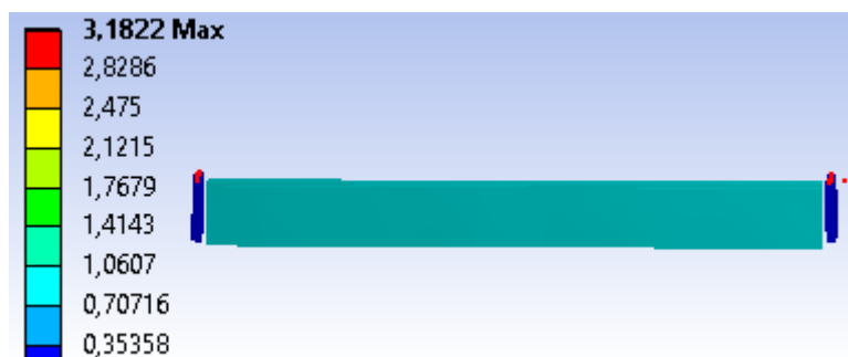
Εικόνες 4-6: Μέγιστο βέλος πετάσματος από χάλυβα ποιότητας S355 με πάχος νεύρωσης 2mm
