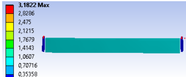
Εικόνες 4-54: Μέγιστο βέλος πετάσματος μήκους 1000mm με πάχος νεύρωσης 2mm
