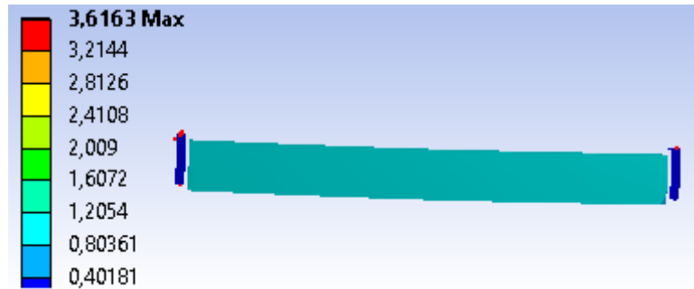
Εικόνες 4-12: Μέγιστο βέλος πετάσματος από χάλυβα ποιότητας S235 με πάχος νεύρωσης 2mm
