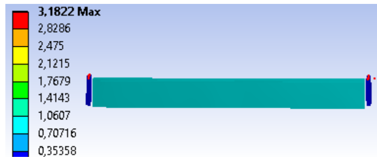
Εικόνες 4-24: Μέγιστο βέλος πετάσματος με απόσταση νευρώσεων 100mm με πάχος νεύρωσης 2mm
