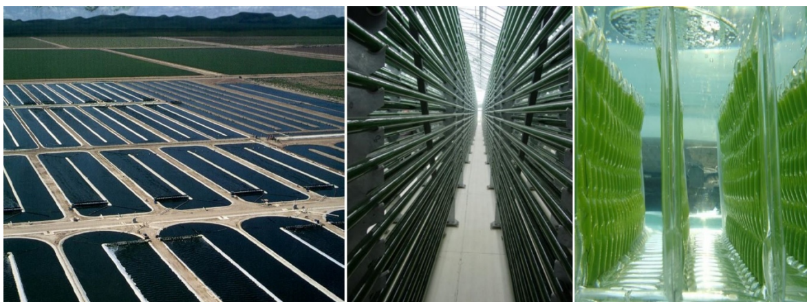
Εικόνα 36. Τρόποι ανάπτυξης μικροάλης. Αριστερά : ανοιχτού τύπου λίμνης, Μέση : ημίκλειστοι αντιδραστήρες, Δεξιά : κάθετα πάνελ πολυαιθυλενίου
