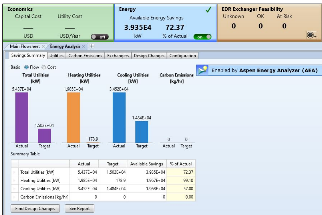
Εικόνα 74. Περιβάλλον Activated Energy Analysis (AEA) στο Aspen Plus για το σενάριο 1
