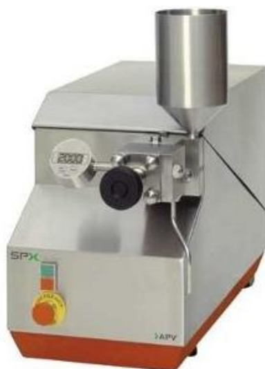
Εικόνα 4.1. Ομογενοποιητής υψηλής πίεσης SPX APV 1000
