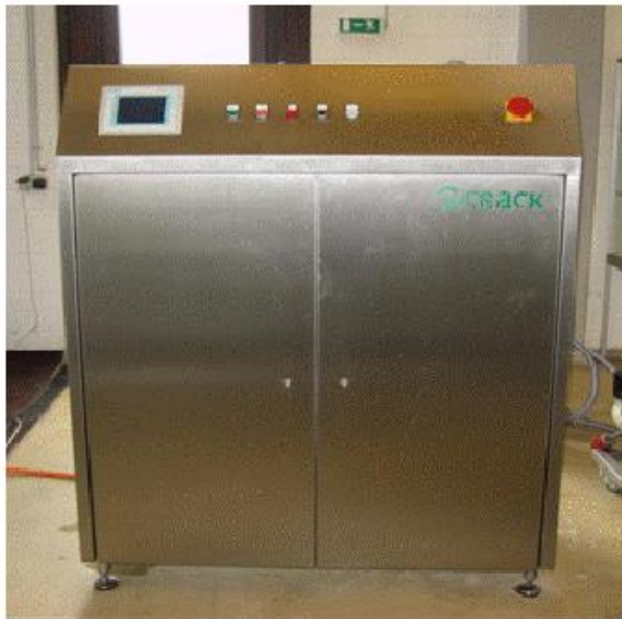
Εικόνα 4.2. Μονάδα παλμικών ηλεκτρικών πεδίων Elcrack-5kW, DIL
