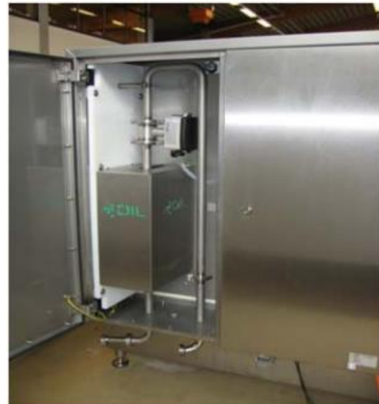
Εικόνα 4.2. Μονάδα παλμικών ηλεκτρικών πεδίων Elcrack-5kW, DIL
