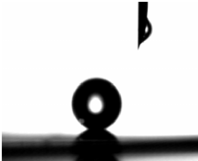
Εικόνα 6.6: Σταγόνα νερού πάνω σε SH επιφάνεια PMMA με επικάλυψη CF. [9]
