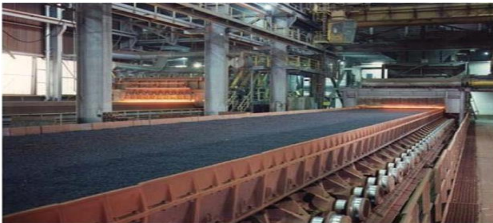
Σχ 2.3. Ζώνη μεταφοράς υλικών για πυροσυσσωμάτωση [21]
