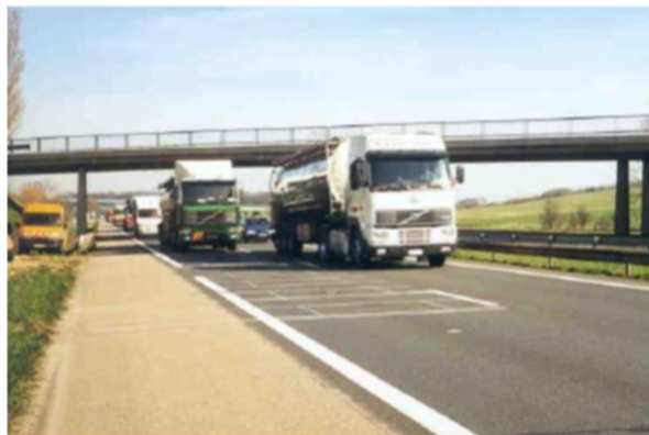
Εικόνα 1.12: Σύστημα WIM με οπτικές ίνες
