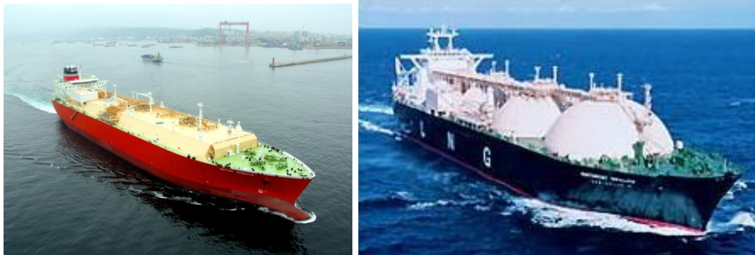
Εικόνα 4-1 Δεξαμενόπλοιο LNG πρισματικού τύπου (αριστερά) και σφαιρικού τύπου (δεξιά) (Πηγή: BV 2009 , GIIGNL 2009)
