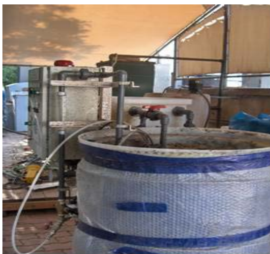
Σχήμα 3.8: Διάταξη πιλοτικού συστήματος MBR: (Α) δεξαμενή πρωτοβάθμιας καθίζησης, (Β) δεξαμενή εξισορρόπησης, (Γ) αερόβιος βιολογικός αντιδραστήρας με εμβαπτιζόμενη μονάδα μεμβρανών, (Δ) δεξαμενή συλλογής εκροής, (Ε) υποβρύχια αντλία, (ΣΤ) μονάδα μεμβρανών, Σημεία δειγματοληψίας: (1) εισροή, (2) ενεργός ιλύς, (3) εκροή
