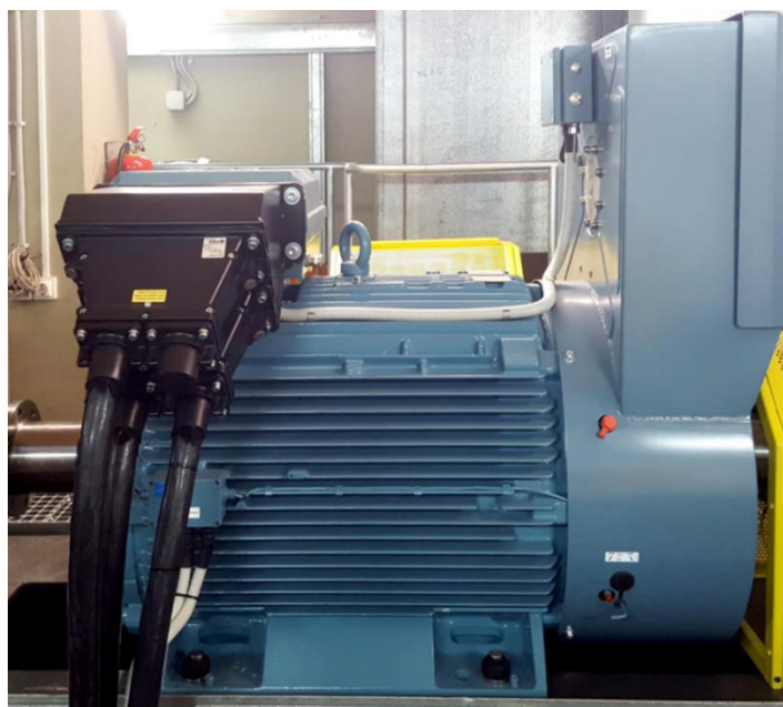
Εικόνα 2.2.2: Ηλεκτρική πέδη ABB
