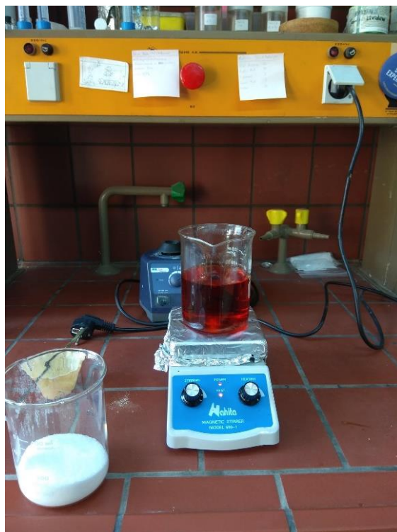
Εικόνα 17- Παρασκευή του αντιδραστηρίου της μεθόδου DNS. Το κόκκινο διάλυμα είναι το Διάλυμα 1 και η λευκή σκόνη το αντιδραστήριο sodium-potassium tartrate (Rochelle salts)
