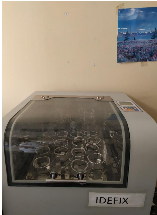
Εικόνα 20-Επωαστήρας που διεξάχθηκε το πείραμα της υδρόλυσης
