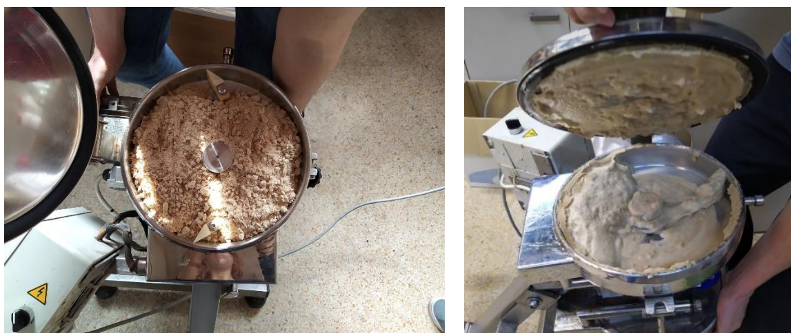
Εικόνα 29-Στην αριστερή εικόνα φαίνεται η διάταξη της υδρόλυσης μεγάλης κλίμακας με το υλικό πριν την υδρόλυση και στην δεξιά εικόνα μετά το πέρας 12 h.
