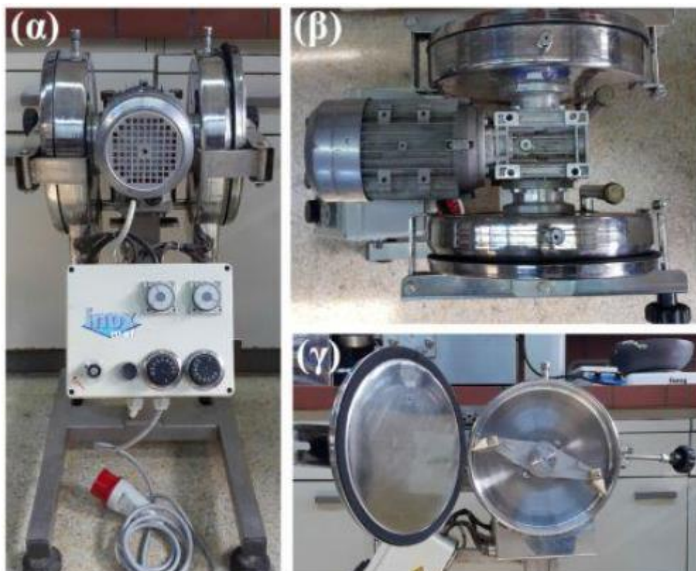
Εικόνα 21-Πρόσοψη(α) και κάτοψη του αναμεικτήρα ελεύθερης πτώσης (β) και το εσωτερικό του θαλάμου με την περιστρεφόμενη προπέλα
