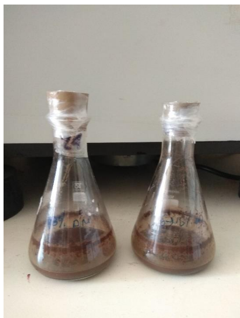
Εικόνα 33-Υδρόλυση βιομάζας στις 24 h. Αριστερά είναι για τελική συγκέντρωση 18% w/w, στη μέση για 20% w/w και δεξιά 22% w/w
