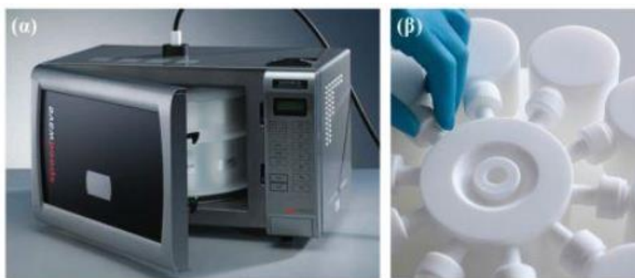
Εικόνα 22-(α) Συσκευή χώνευσης με μικροκύματα, (β) δοχεία για την προκατεργασία των δειγμάτων
