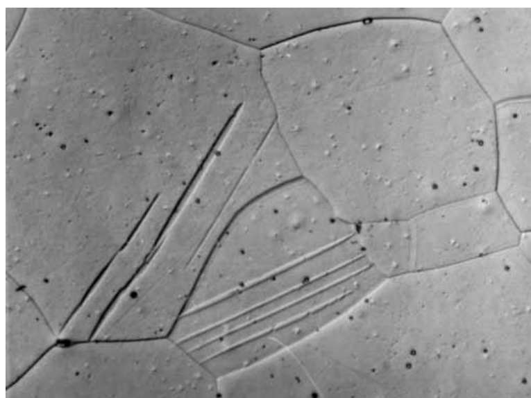
Εικόνα 14: Διδυμίες παραμόρφωσης σε έναν 26Cr - 1Mo ανοξείδωτο χάλυβα [33]
