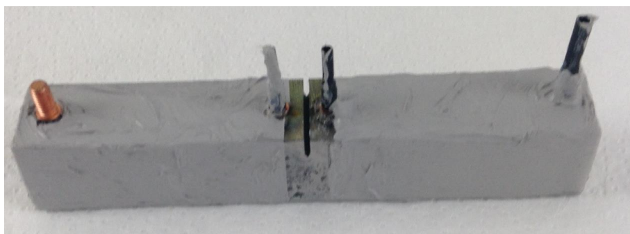
Εικόνα 53: Φωτογραφία μονωμένου δοκιμίου χάλυβα X65 πριν την καθοδική φόρτιση
