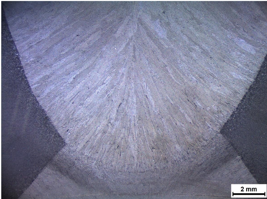
Εικόνα 47: Μακροσκοπική απεικόνιση της συγκόλλησης χάλυβα X65 μέσω Στερεοσκοπίου
