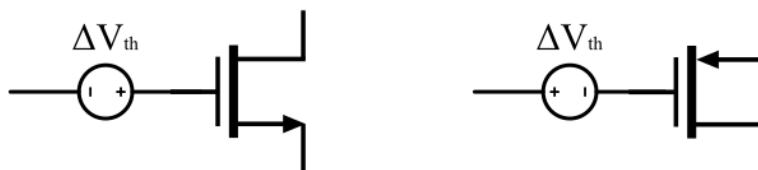
Figure 3.1: Σχηματικά τα μοντέλα τρανζίστορ που χρησιμοποιήθηκαν
