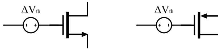
Σχήμα 4: Σχηματικά τα μοντέλα τρανζίστορ που χρησιμοποιήθηκαν
