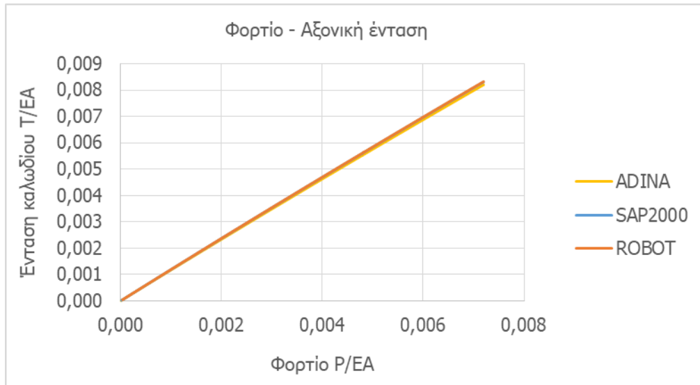
Σχήμα 6-24: Ένταση καλωδίου με κρέμαση ( S_0=1.10 \times L ) υπό συγκεντρωμένο φορτίο ως συνάρτηση του φορτίου
