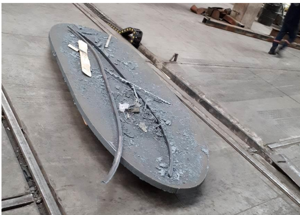
Σχήμα 2-18: Τμήμα που αποκόπτεται μετά τη διάνοιξη οπής ανθρωποθυρίδας (Πηγή:Εταιρεία Ates Wind Power)
