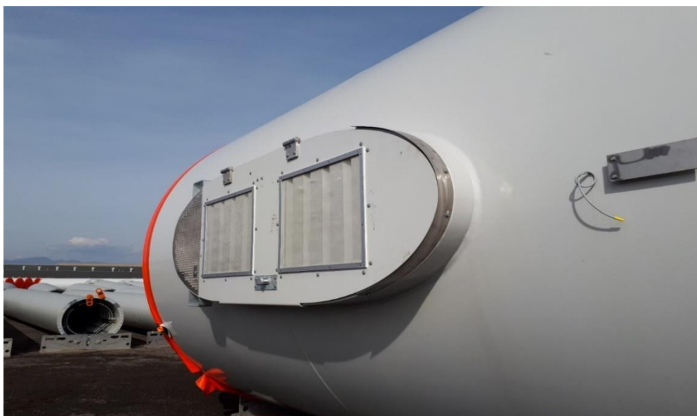
Σχήμα 2-22: Τοποθέτηση θύρας ανθρωποθυρίδας (Πηγή:Εταιρεία Ates Wind Power)
