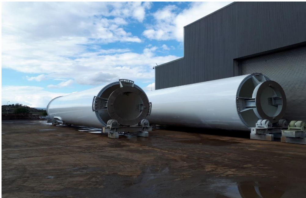
Σχήμα 2-21: Κυλινδρικό τμήμα μήκους 20m έως 30m μετά τη βαφή (Πηγή:Εταιρεία Ates Wind Power)
