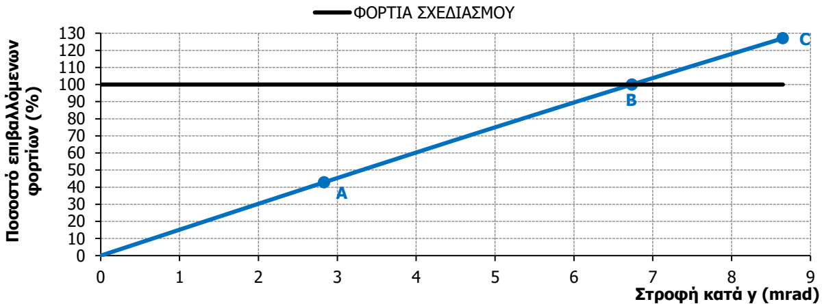
Σχήμα 5-12: Δρόμος ισορροπίας ποσοστού φόρτισης – στροφής προσομοιώματος στη θέση 1
