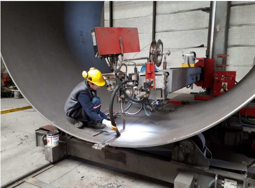
Σχήμα 2-11: Δημιουργία κλειστού κυλινδρικού κελύφους με διαμήκη εσωραφή πλήρους διείσδυσης (εσωτερική πλευρά) (Πηγή:Εταιρεία Ates Wind Power)
