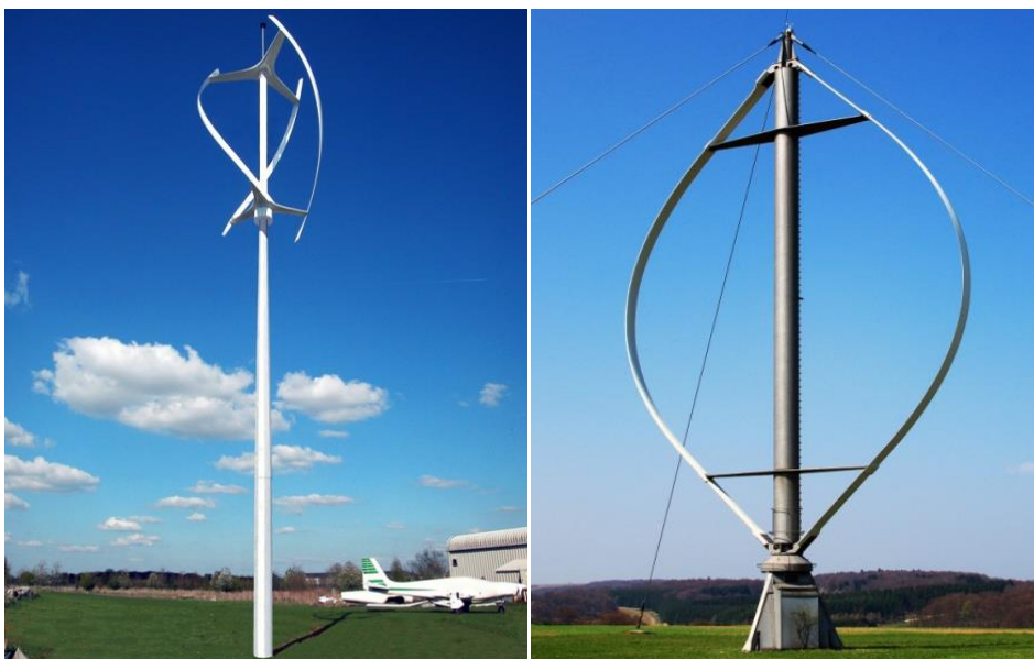
Σχήματα 1-10: Ανεμογεννήτριες κατακόρυφου άξονα (Πηγή: www.zeroenergybuildings.org )
