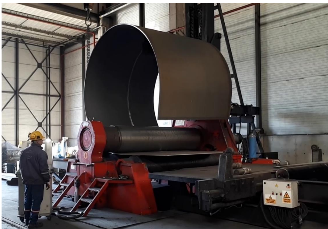
Σχήμα 2-10: Διαδικασία καμπύλωσης επίπεδων ελασμάτων (Πηγή:Εταιρεία Ates Wind Power)
