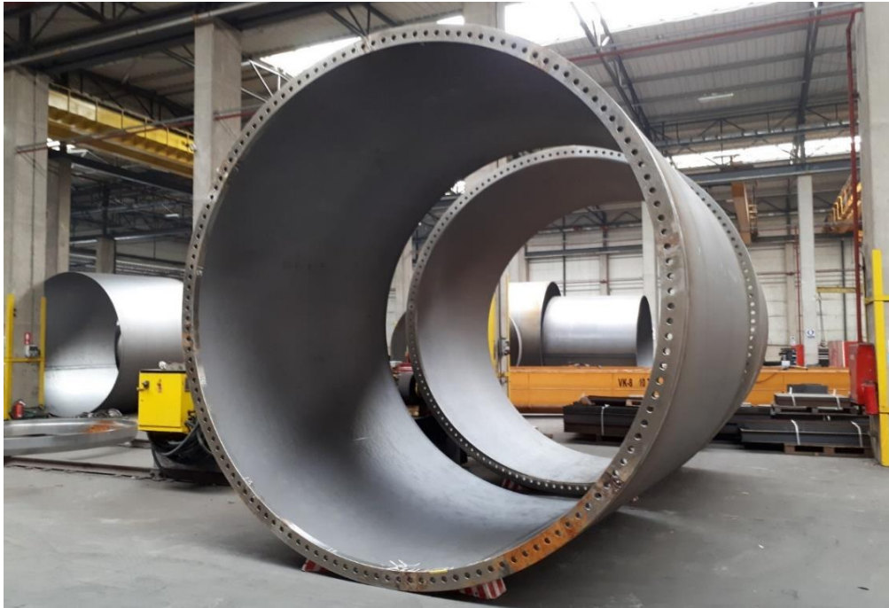
Σχήμα 2-15: Κυλινδρικά τμήματα με συγκολλημένα δακτυλιοειδή πέλματα στο ένα άκρο (Πηγή:Εταιρεία Ates Wind Power)
