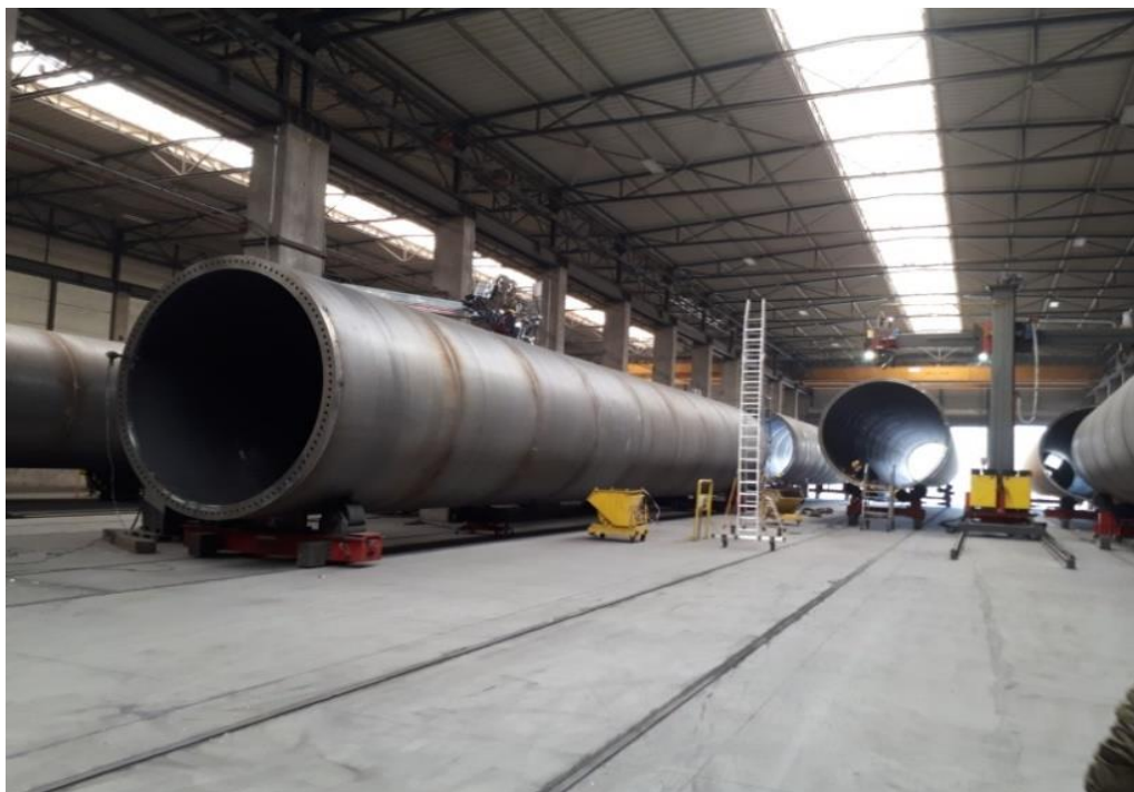
Σχήμα 2-17: Κυλινδρικό τμήμα μήκους 20m ως 30m με συγκολλημένα δακτυλιοειδή πέλαμα στα άκρα του (Πηγή:Εταιρεία Ates Wind Power)
