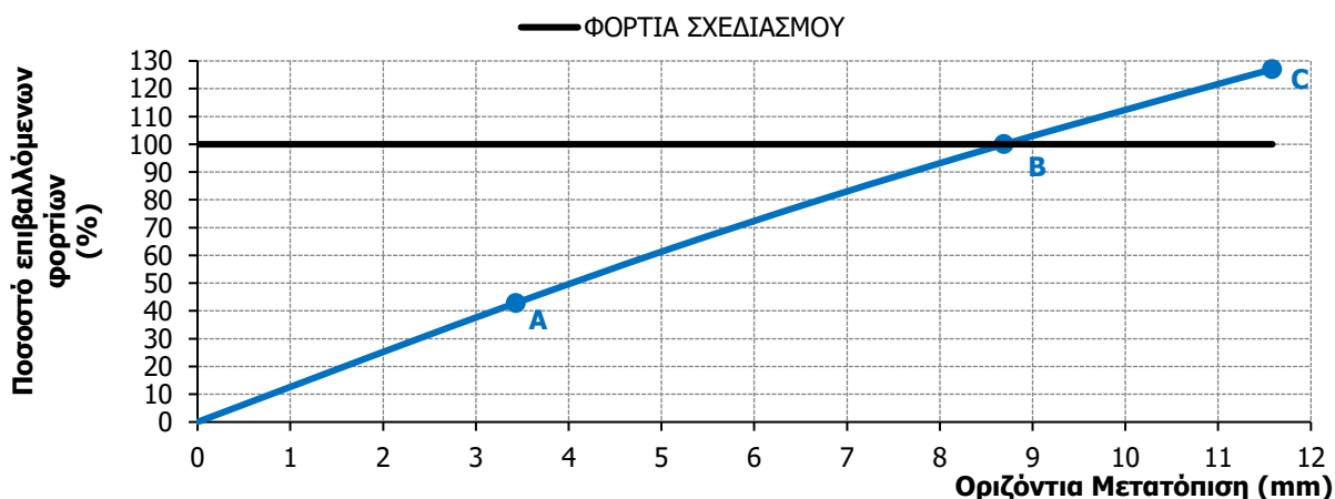
Σχήμα 5-16: Δρόμος ισορροπίας ποσοστό φόρτισης – μετατόπισης προσομοιώματος στο θέση 2
