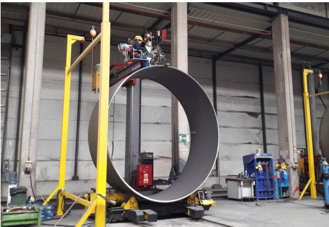
Σχήμα 2-12: Δημιουργία κλειστού κυλινδρικού κελύφους με διαμήκη εσωραφή πλήρους διείσδυσης (εξωτερική πλευρά) (Πηγή:Εταιρεία Ates Wind Power)
