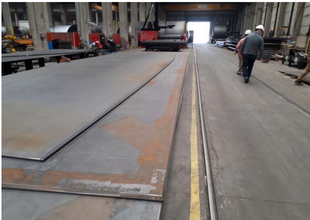
Σχήμα 2-9: Επίπεδα ελάσματα με διαμορφωμένες (φρεζαρισμένες) ακμές (Πηγή:Εταιρεία Ates Wind Power)
