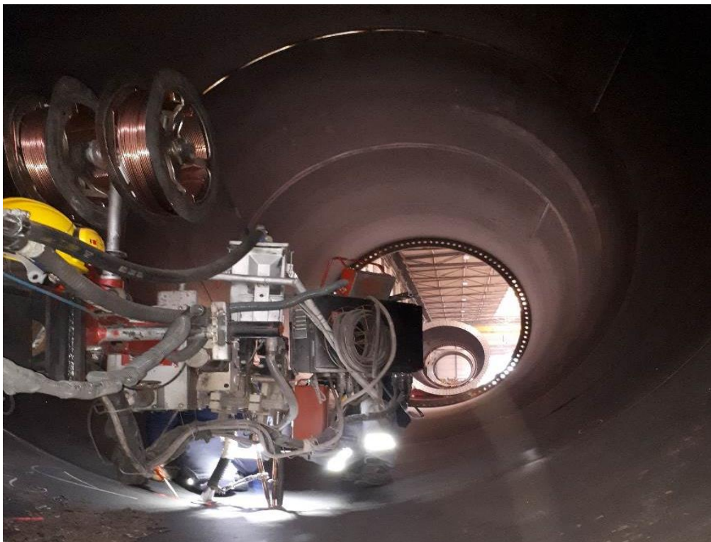
Σχήμα 2-16: Συγκόλληση διαδοχικών κυλινδρικών τμημάτων μεταξύ τους (Πηγή:Εταιρεία Ates Wind Power)
