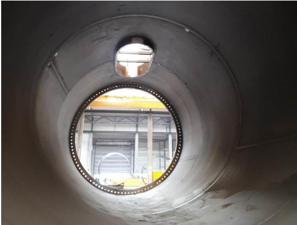
Σχήμα 2-19: Κυλινδρικό τμήμα με διανοιγμένη και ενισχυμένη οπή ανθρωποθυρίδας (Πηγή:Εταιρεία Ates Wind Power)
