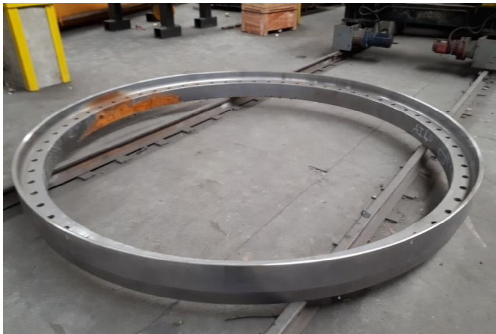
Σχήμα 2-14: Δακτυλιοειδές πέλαμα σύνδεσης μεταξύ διαδοχικών τμημάτων πυλώνων ανεμογεννητριών (οπές για απλή σειρά κοχλιών) (Πηγή:Εταιρεία Ates Wind Power)
