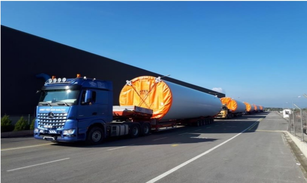
Σχήμα 2-23: Μεταφορά τμημάτων πυλώνα ανεμογεννητριών (Πηγή:Εταιρεία Ates Wind Power)
