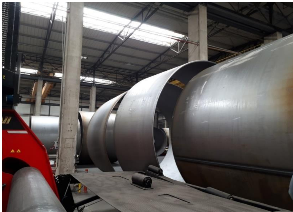
Σχήμα 2-13: Κυλινδρικά τμήματα διαμέτρου 3m ως 4m και ύψους 2m ως 3m (Πηγή:Εταιρεία Ates Wind Power)
