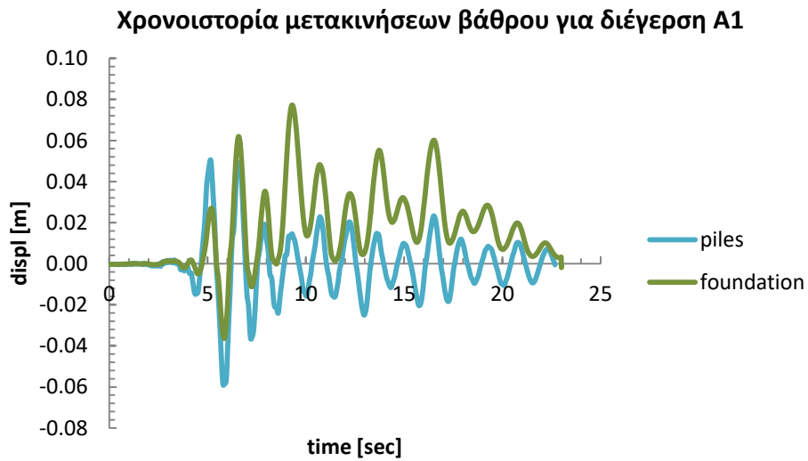
Σχήμα 110: Χρονοϊστορία μετακινήσεων κορυφής βάρου για σεισμό A 1
