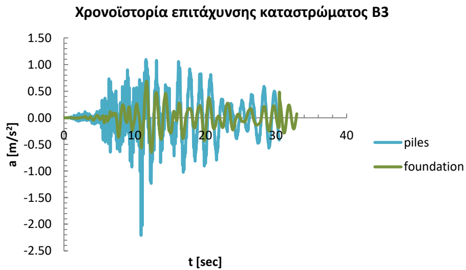
Σχήμα 133: Χρονοϊστορία απόλυτων επιταχύνσεων καταστρώματος για σεισμό Β 3
