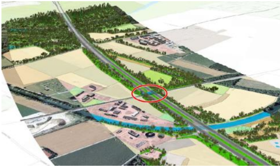
Εικόνα 4.6: Ενσωμάτωση των A99 BIM δεδομένων σε 3D περιβάλλον GIS Πηγή: Schaller, Gnaedinger, Reith, Freller, Mattos, 2017
