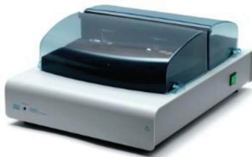
Σχήμα 5.10 Ααντιδραστήρας οξείδωσης (Oxitest®, Velp Scientifica, Usmate, Milan, Italy).
