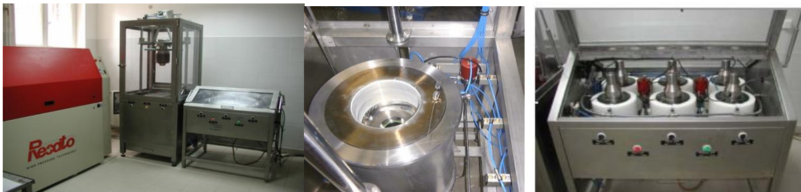
Σχήμα 5.11 Εξοπλισμός Υπερυψηλής Πίεσης (μονάδα Food Pressure Unit FPU 1.01 της Resato International BV – Roden, The Netherlands)
