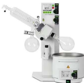
Σχήμα 5.2. Περιστροφικός εξατμιστήρας (Rotavapor RE 111, Büchi, Switzerland)
