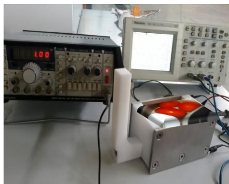
Σχήμα 5.3. Διάταξη για τον προσδιορισμό του δείκτη κυτταρικής διάρρηξης Z με τη μέθοδο υψηλών-χαμηλών συχνοτήτων ,με τον θάλαμο εξεργασίας, τη γεννήτρια συχνοτήτων Newtronics 200LTPC και τον παλμογράφο Tektronix TDS1012.
