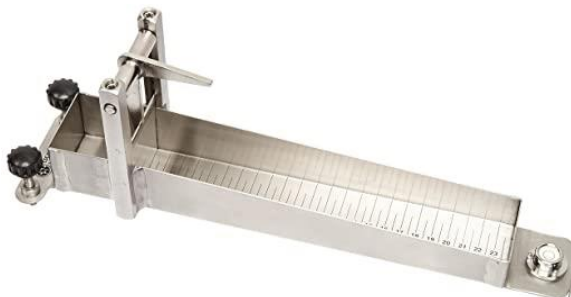
Σχήμα 5.10 Όργανο μέτρηση της συνεκτικότητας κατά Bostwick (Camlab 1179568 Bostwick Consistometer, Extended Length, 30 cm)
