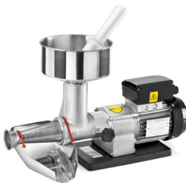
Σχήμα 5.5. Ραφινέζα (SpremiTO, Tre Spade, Torino, Ιταλία) που χρησιμοποιήθηκε για τα πειράματα της χυμοποίησης τοματών
