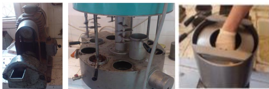
Σχήμα 5.7. Σπαστήρας, μαλακτήρας και φυγόκεντρος εργαστηριακής κλίμακας για την παραγωγή ελαιόλαδου του εργαστηρίου Μηχανικής Τροφίμων του ΕΛΓΟ ΔΗΜΗΤΡΑ.
