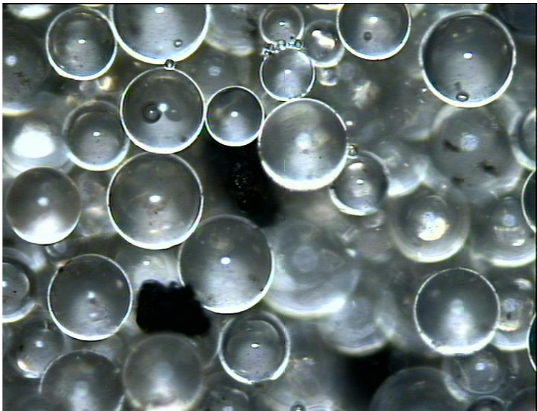
Εικόνα 49: Φωτογραφία από το οπτικό μικροσκόπιο. Μικρόσφαιρες PMMA/Fe 3 O 4 1.40wt% (125µm).
