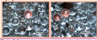
Εικόνα 7. Φωτογραφίες από το οπτικό μικροσκόπιο (α) μικροσφαίρες PMMA/α-Fe 2 O 3 1.25wt% (125μm) (β) μικροσφαίρες PMMA/α-Fe 2 O 3 2.50wt% (125μm).
