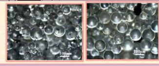
Εικόνα 9. Φωτογραφίες από το οπτικό μικροσκόπιο (α) μικροσφαίρες PMMA/Fe 3 O 4 1.25wt% (125μm) (β) μικροσφαίρες PMMA/α-Fe 2 O 3 2.50wt% (125μm).
