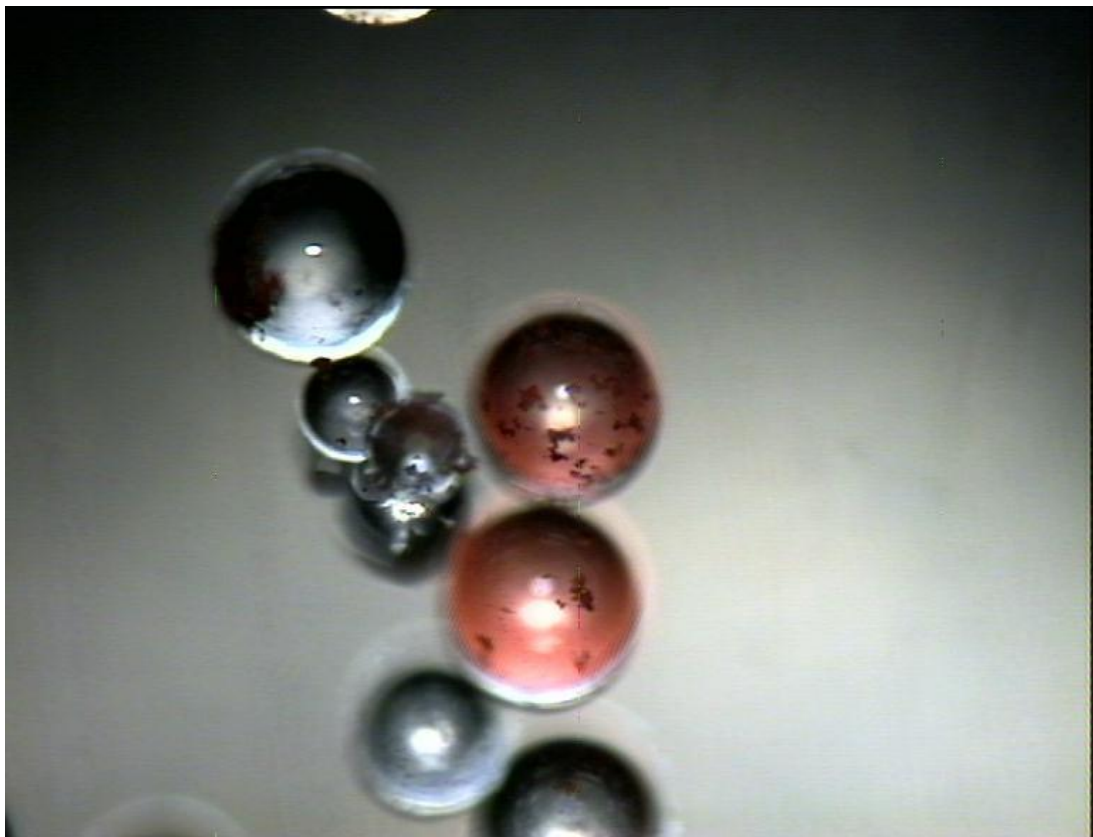
Εικόνα 51: Φωτογραφία από το οπτικό μικροσκόπιο. Μικρόσφαιρες PMMA/γ-Fe 2 O 3 0.88wt% (125μm).
