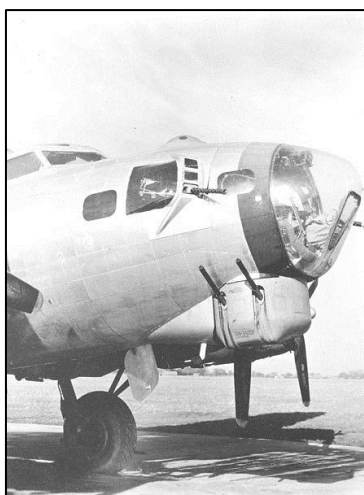
Εικόνα 7: B-17G πλεξιγκλάς βομβαρδιστικό. Τμήμα μύτης με PMMA.
