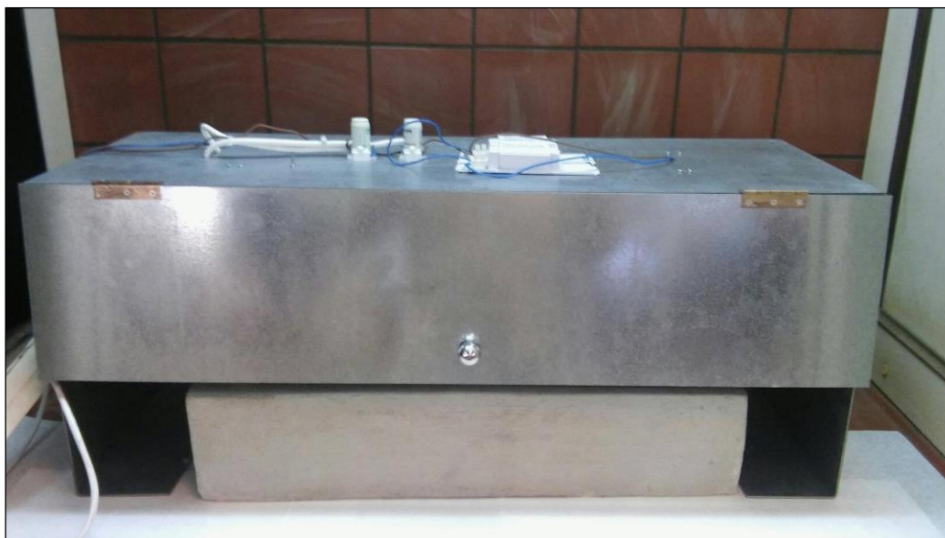
Εικόνα XI: Διάταξη φωτοκαταλυτικού αντιδραστήρα εξωτερικά.
