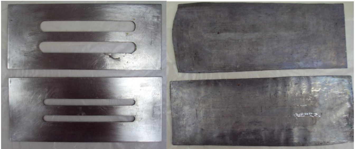
Εικόνα 3. Αντικολλητικό μέσο βαφής καλουπιού
