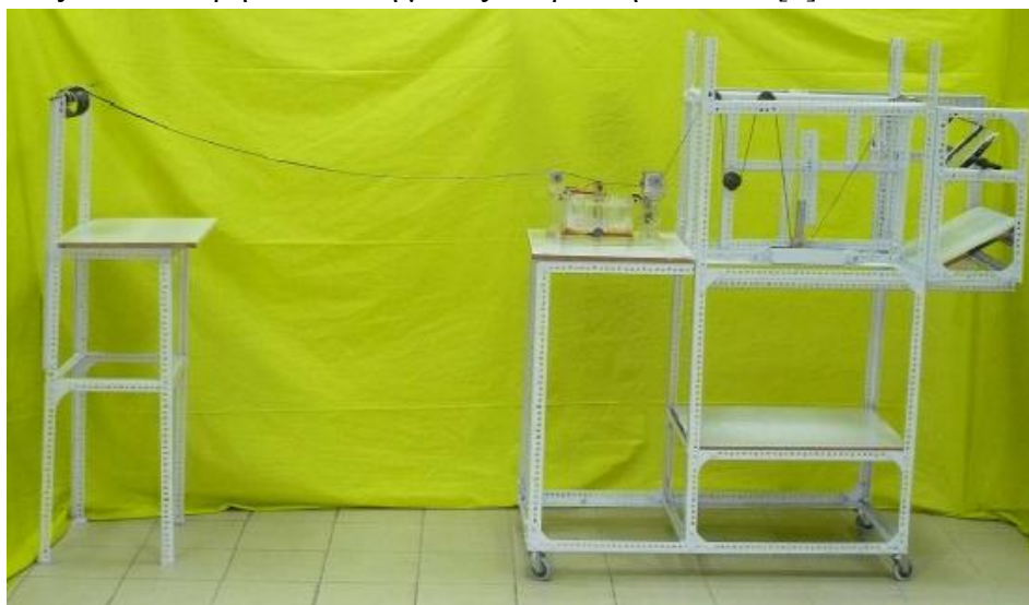
Εικόνα 1. Διάταξη διαβροχής των ινών άνθρακα .
