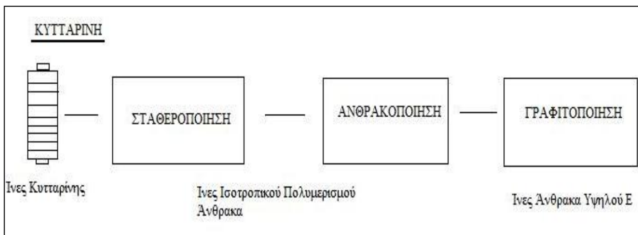
Σχήμα 14. Σχηματική παράσταση της παραγωγής ινών άνθρακα από κυτταρίνη [13].
