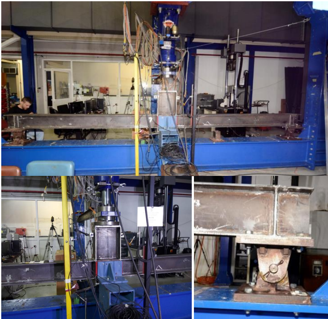
Εικόνα 2.3 Διάταξη πειράματος 1 στο Εργαστήριο Μεταλλικών κατασκευών
