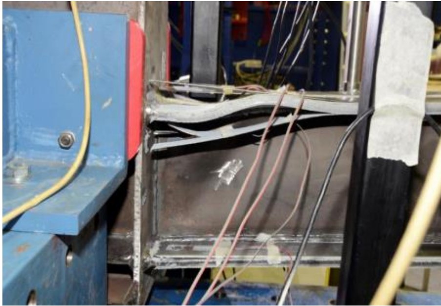
Εικόνα 2.14 Θραύση ελάσματος CFRP
