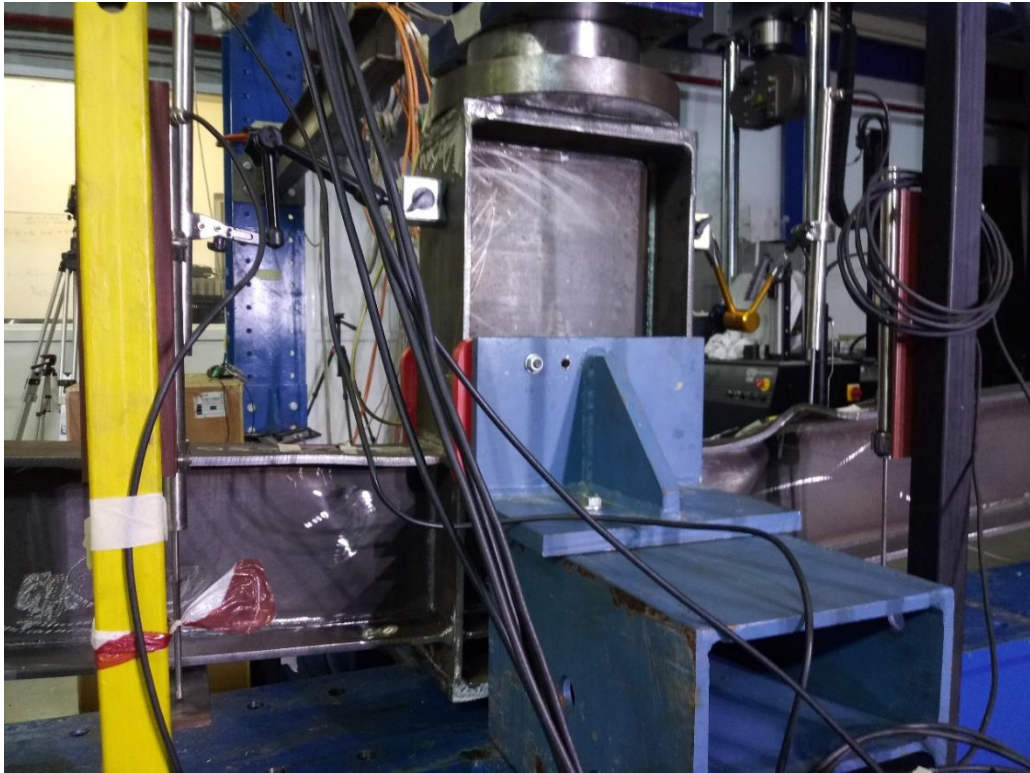
Εικόνα 2.8 Αστοχία - Πλαστικοποίηση θλιβόμενου πέλματος
