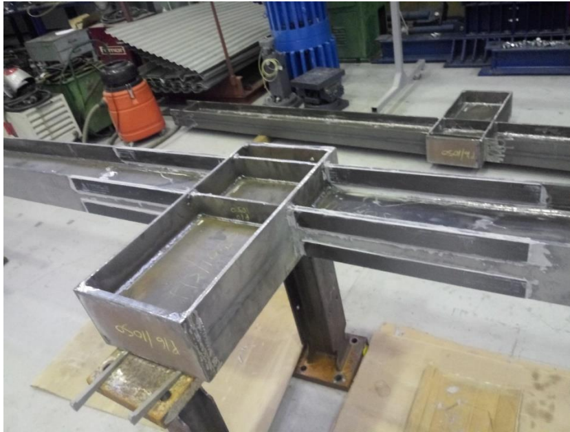
Εικόνα 2.10 Προετοιμασία μοντέλου για το πείραμα 2 - ενίσχυση με CFRP
