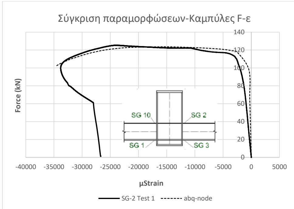
Σχήμα 3.2 Σύγκριση παραμορφώσεων συγκεκριμένου σημείου στο θλιβόμενο πέλμα της δοκού
