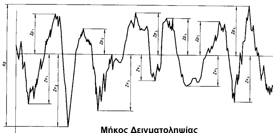
εικ. 2.2.1.10 Μέγιστο ύψος προφίλ, (παράδειγμα προφίλ τραχύτητας), [111]
