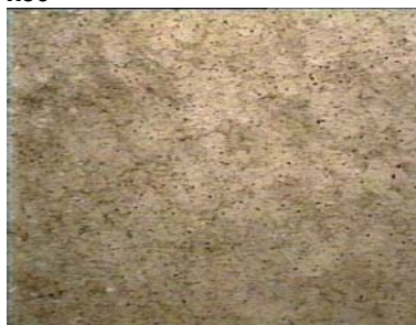
Περικρυσταλλικές ρηγματώσεις και έντονες μαύρες επικαθήσεις, x25
