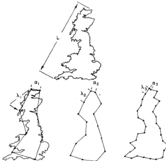
Εικόνα 2.2.2.1 Σχηματική αναπαράσταση της μεθόδου του Richardson με χρήση πολυγώνων για την εύρεση της περιμέτρου της Μεγάλης Βρετανίας
