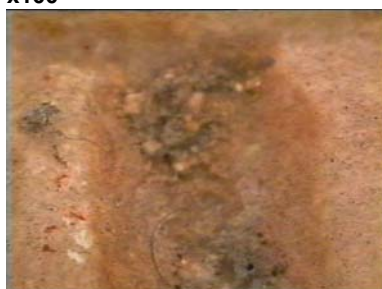
φαιόμαυρη κρούστα, κιονόκρανο, δεξί τμήμα, (ανατολικός προσανατολισμός), x100
