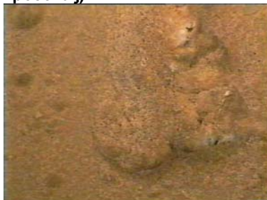
Σηπιόλιθος και απιονισμένο νερό 3:30h x50 (περιοχή εύθρυπτης φαιόμαυρης κρούστας)
