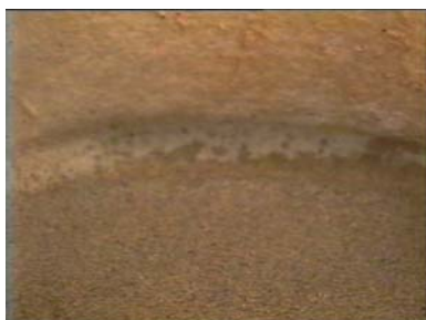
φαιόμαυρη κρούστα, κιονόκρανο, δεξί τμήμα, (ανατολικός προσανατολισμός), x50
