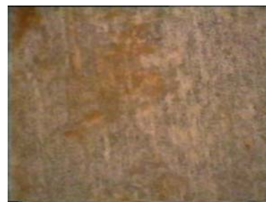
ιοντοανταλλακτική ρητίνη με ανθρακικό αμμώνιο 40min, ράβδωση, x25
