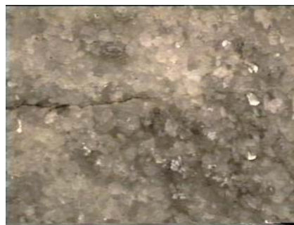
Ζαχαροειδής φθορά, Εικόνα Μικροσκοπίας Οπτικών Ινών, x50, [60]
