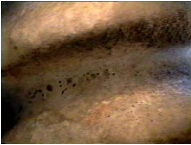
φαιόμαυρη κρούστα, κιονόκρανο, αριστερό τμήμα, (ανατολικός προσανατολισμός), x100
