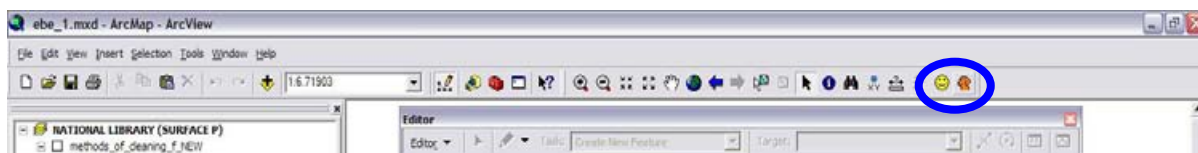
Εικ. 10.1.2: Επιπλέον κουμπιά στη γραφική διεπιφάνεια του ΓΣΠ για τη δημιουργία των ενδιάμεσων αρχείων των παραμέτρων εισόδου και της παραμέτρου εξόδου του επιλύτη
