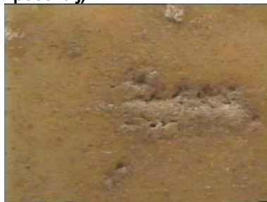
Σηπιόλιθος και απιονισμένο νερό 3h, x25 (περιοχή συνεκτικής φαιόμαυρης κρούστας)
