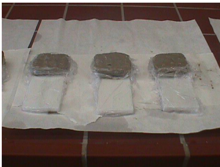
Εικ. 4.1.1 Πρότυπα δοκίμια πεντελικού μαρμάρου, κατά τη διάρκεια εφαρμογής της Πάστας AB57
