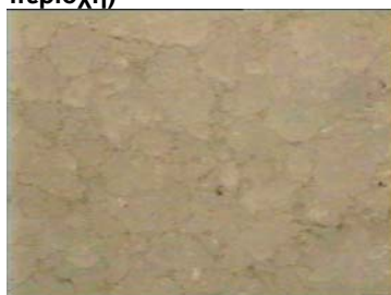
10% (\text{NH}_4)_2\text{CO}_3 1,5h, x25 (περιοχή με μαύρες επικαθίσεις)
