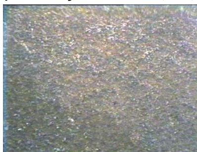
Φαιόμαυρη κρούστα, Εικόνα Μικροσκοπίας Οπτικών Ινών, x25, [61]
