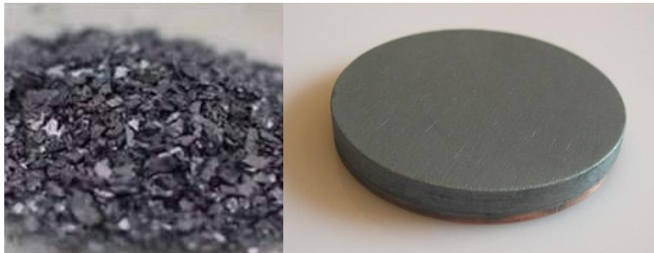
Εικόνα 2.2.2 : Αριστερά τελλουριούχο βυσμούθιο και δεξιά θερμοστοιχείο από τελλουριούχο μόλυβδο
