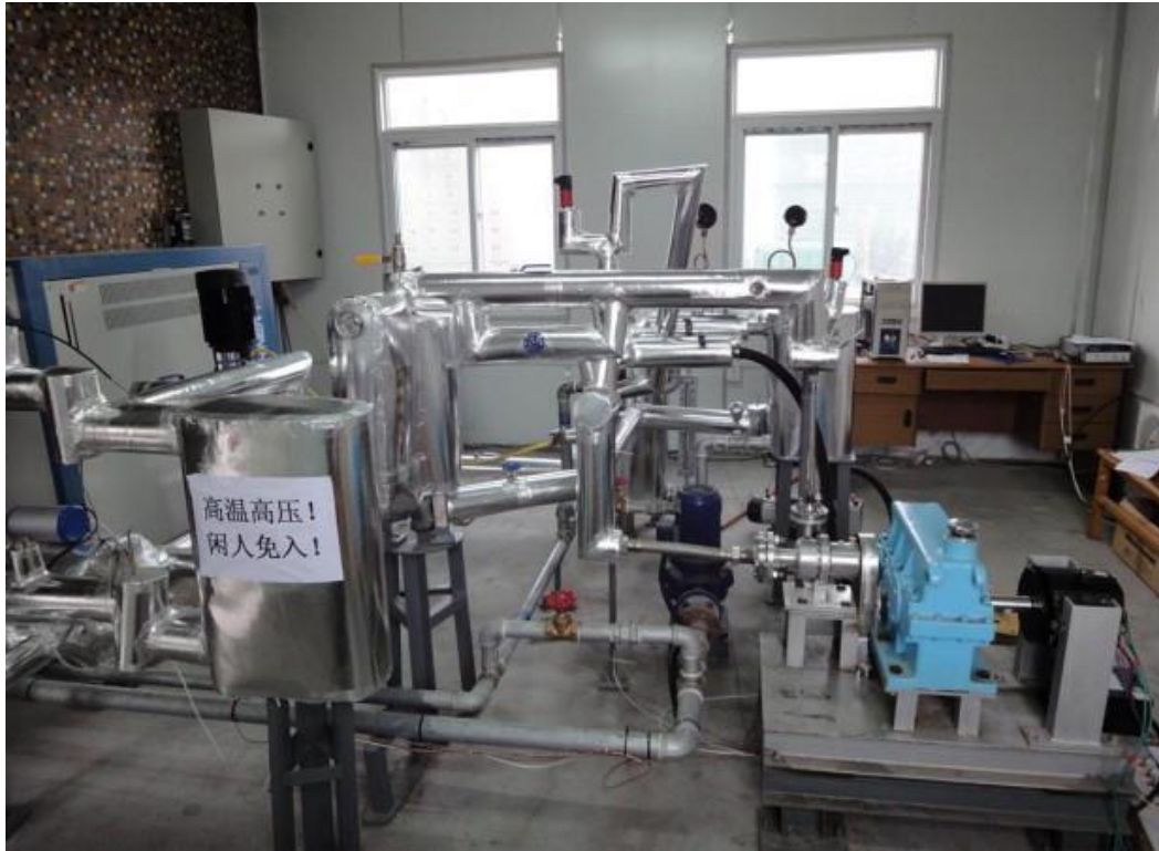
Εικόνα 1.6.5 : Διάταξη του συστήματος ORC
