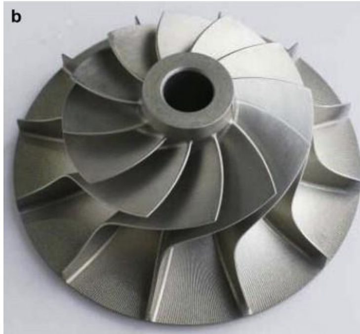
Εικόνα 1.6.4 : Οι λεπίδες του χρησιμοποιούμενου στρόβιλου
