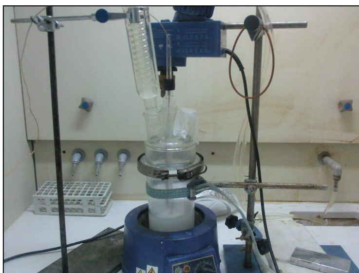
Εικόνα 30 Εργαστηριακή διάταξη για τον πολυμερισμό αιωρήματος, PMMA, PS
