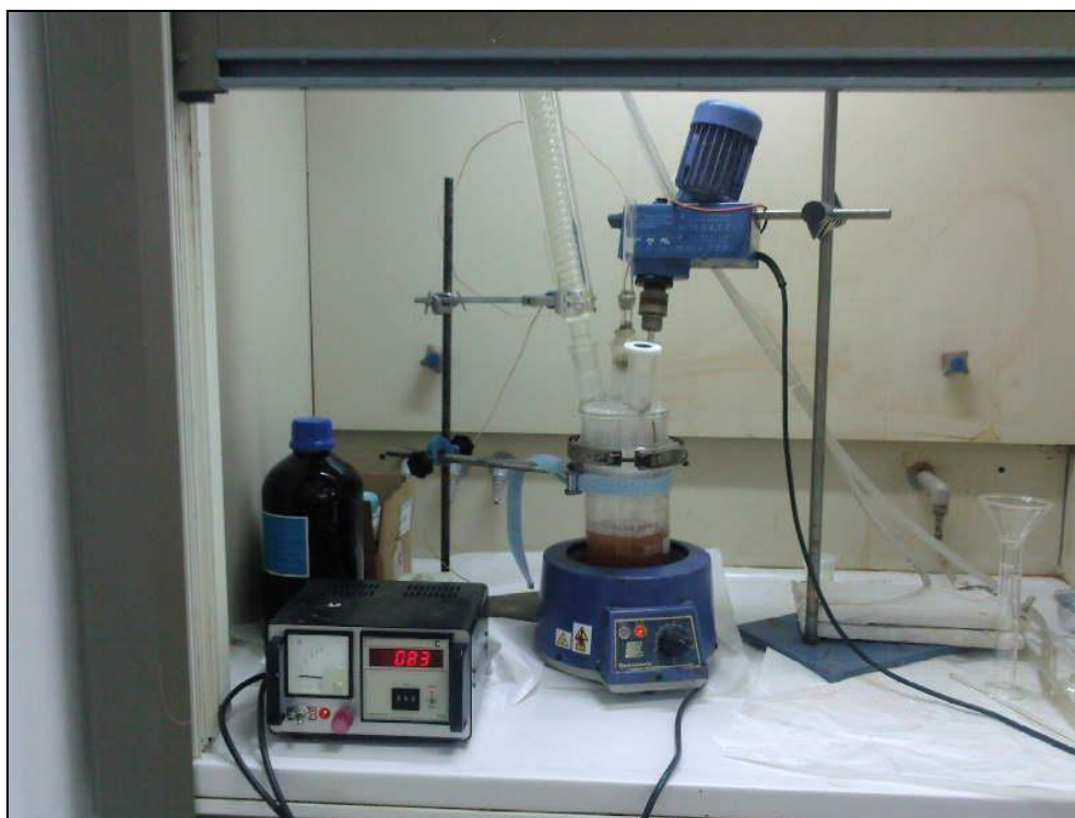
Εικόνα 31. Εργαστηριακή διάταξη για τον πολυμερισμό αιωρήματος, PMMA, PS – \alpha\text{-Fe}_2\text{O}_3
