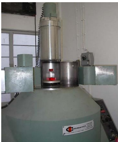
Εικόνα 25: Ακτινοβολητής Gammacell 200 Irradiator πηγής κοβαλτίου ^{60}\text{Co} .
