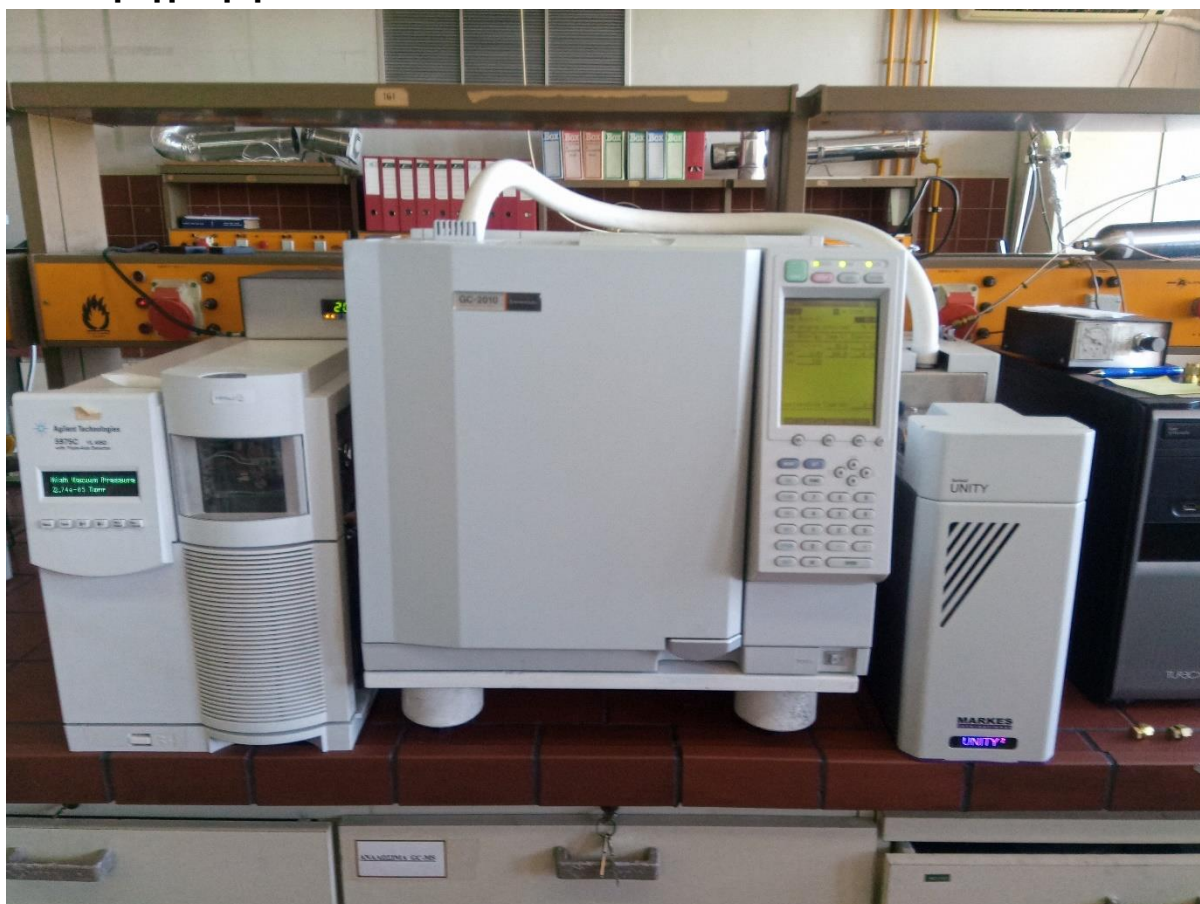
Εικόνα 21: Η διάταξη οργάνων TDU-GC-MS που χρησιμοποιήθηκε
