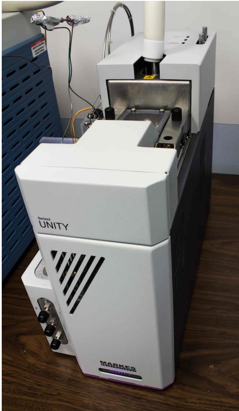
Εικόνα 9: Thermal Desorption Unit. Μοντέλο Unity της εταιρίας Markes
