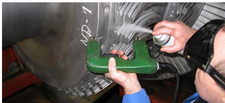
Σχήμα 22: Χρήση της μεθόδου ελέγχου μέσω μαγνητικών σωματιδίων, ©TÜV Rheinland
