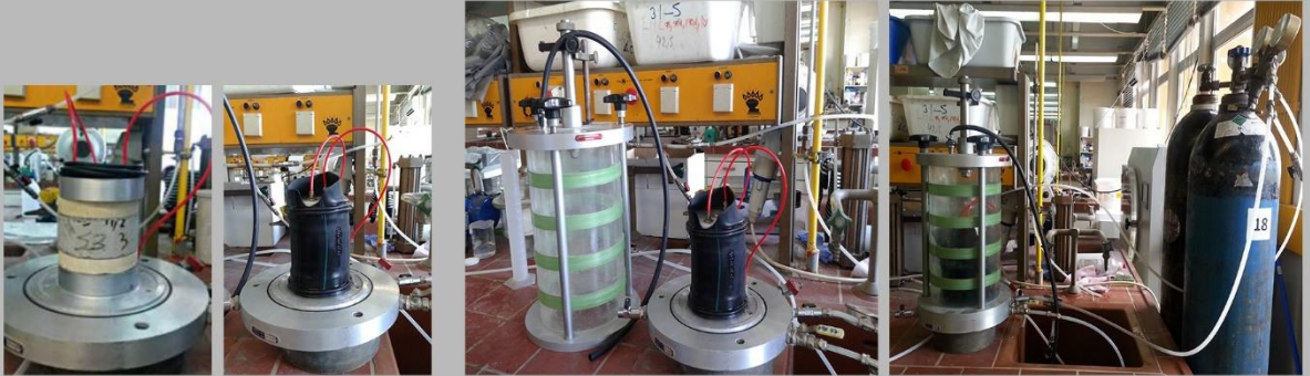
Σχήμα 5.4 : Τοποθέτηση ελαστικού σωλήνα από καουτσούκ, Το περίβλημα της τριαξονικής κυψέλης και οι φιάλες N2
