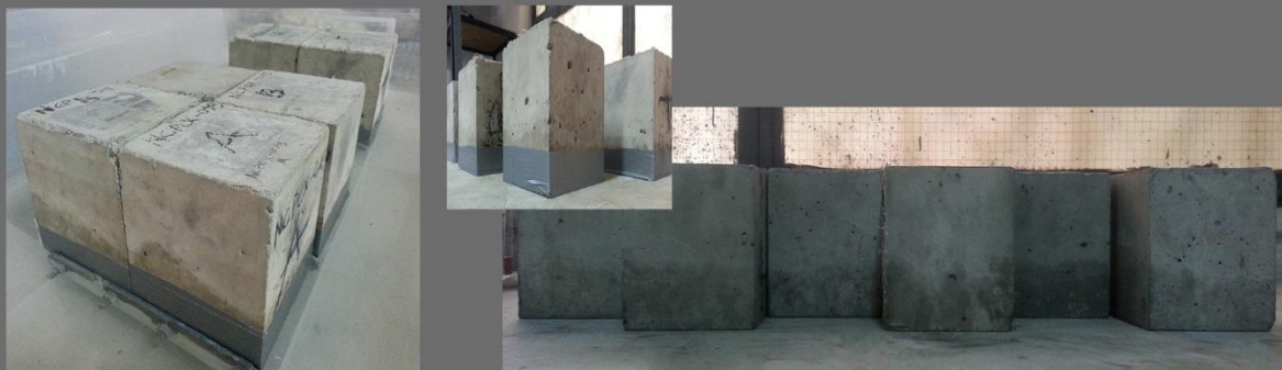
Σχήμα 5.3 : (α) Εκτέλεση δοκιμής σε πρότυπα κυβικά δοκίμια (100x100x100 mm) που φέρουν πλευρική στεγάνωση και (β) Τα δοκίμια μετά το πέρας του πειράματος τριχοειδούς απορρόφησης
