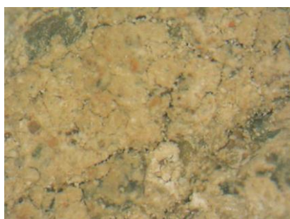
κονίαμα Υπογείου (FOM x50)
