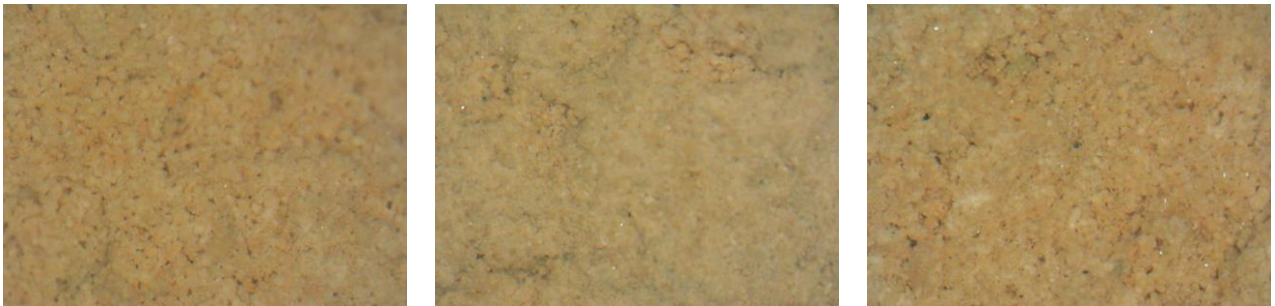
D12_sb: Πορώδης λίθος ανοιχτού καστανού χρωματισμού θέσης 2 1 ου ορόφου x50, x50, x50
