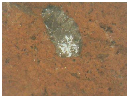
κόκκινος οπτόπλινθος Υπογείου (FOM x50)
