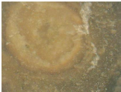
γκρίζος συμπαγής ασβεστόλιθος (FOM x50)
