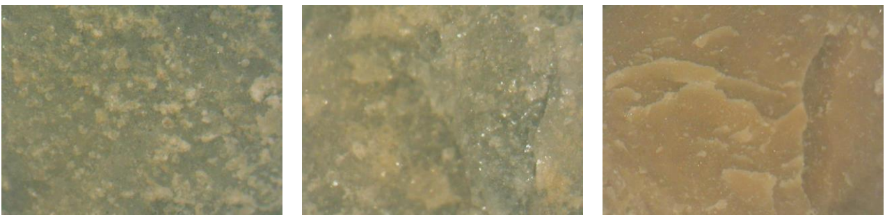
DG1_s2: Γκριζος συμπαγής ασβεστόλιθος θέσης 1 Ισογείου x50, x50, x50
