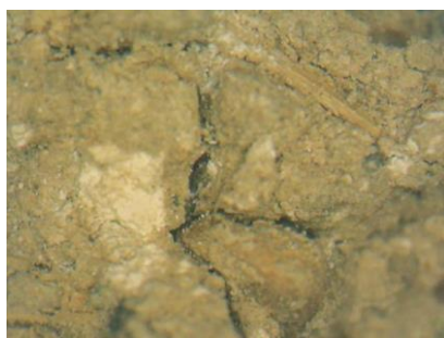
επίχρισμα Υπογείου θέσης 2 (FOM x50)
