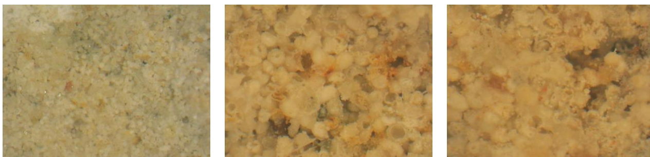
DB3_s2: Ασβεστόλιθος με σφαιροειδείς κόκκους θέσης 3 Υπογείου x50, x120, x120
