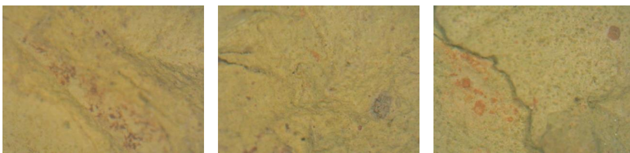
D12_cy: Κίτρινος οπτόπλινθος θέσης 2 1 ου ορόφου x50, x50, x50
