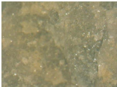
γκρίζος συμπαγής ασβεστόλιθος (FOM x50)
