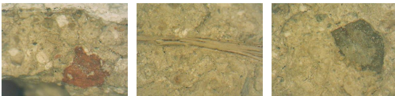
DB3_p: Επίχρισμα θέσης 3 Υπογείου x30, x30, x30
