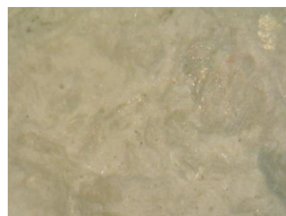
άμορφο υαλώδες ηφαιστειακό πέτρωμα εξαιρετικά πορώδες (FOM x50)
