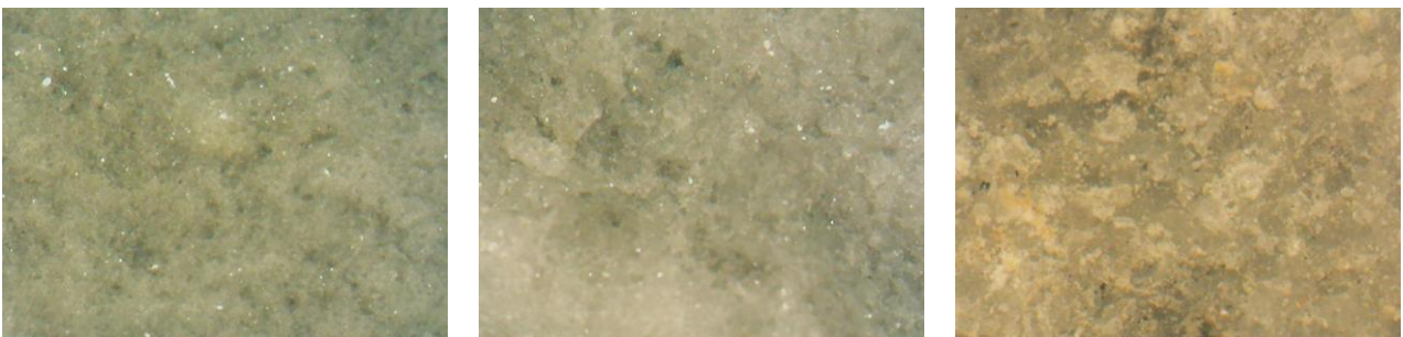
D22_sg: Γκριζος ασβεστόλιθος θέσης 2 2 ου ορόφου x30, x50, x120
