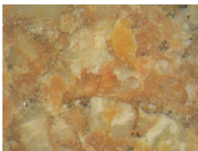
συμπαγής κροκαλοπαγής ασβεστόλιθος (ενδοσπαρίτης) (FOM x30)
