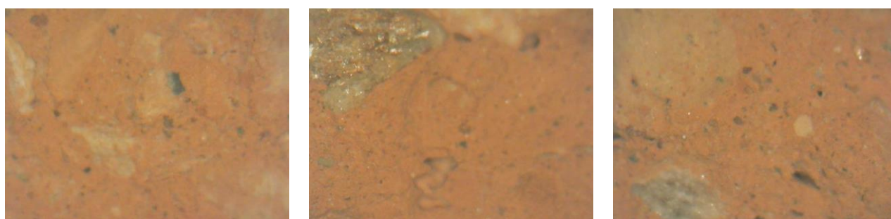
DG2_cr: Κόκκινος οπτόπλινθος θέσης 2 Ισογείου x50, x50, x50
