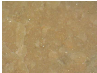
υπόλευκος συμπαγής ασβεστόλιθος (FOM x50)
