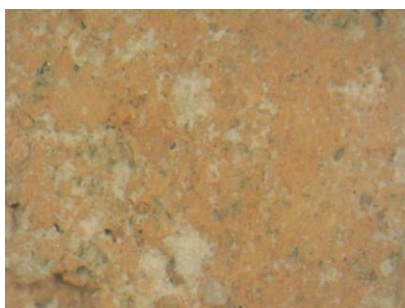
υπόστρωμα επιχρίσματος Ισογείου θέσης 2 (FOM x50)
