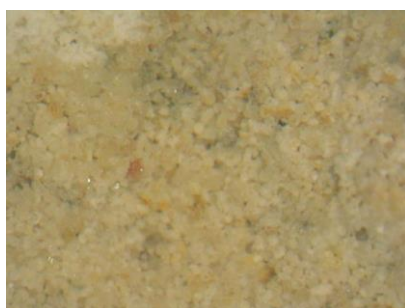
πορώδης απολιθωματοφόρος ασβεστόλιθος (ωμομικρίτης) (FOM x50)
