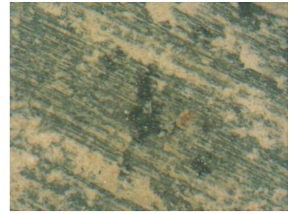
κάρβουνο στο υπόστρωμα επιχρίσματος 2 ου ορόφου (FOM x50)
