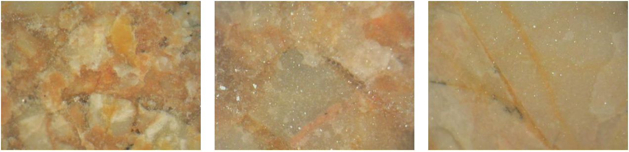
D22_sr: Ποικιλόμορφος κροκαλοπαγής ασβεστόλιθος θέσης 2 2 ου ορόφου x30, x50, x50
