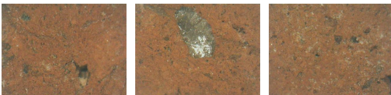
DB3_cr: Κόκκινος οπτόπλινθος θέσης 3 Υπογείου x50, x50, x50
