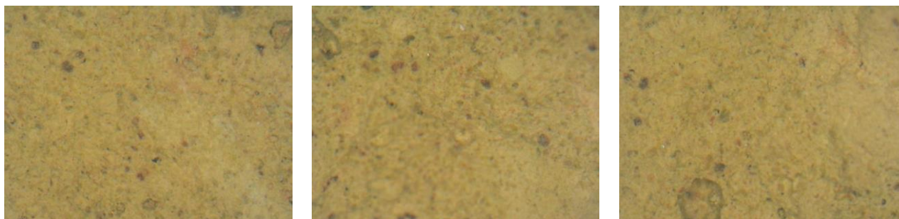
D23_cy: Κίτρινος οπτόπλινθος θέσης 3 2 ου ορόφου x50, x50, x50
