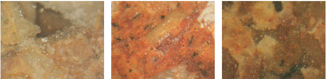
D22_sr: Ποικιλόμορφος κροκαλοπαγής ασβεστόλιθος θέσης 2 2 ου ορόφου x50, x50, x120
