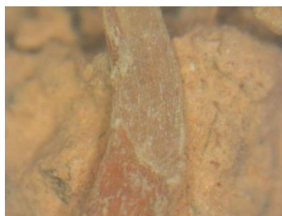
υπόστρωμα επιχρίσματος Ισογείου θέσης 1 (FOM x50)
