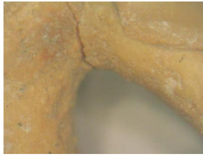
δόντι στο υπόστρωμα επιχρίσματος 2 ου ορόφου (FOM x50)
