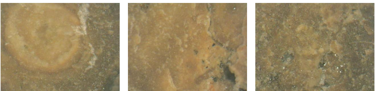
D11_sg: Φαιοκάστανος – γκριζος ασβεστόλιθος με σφαιροειδείς σχηματισμούς θέσης 1 1 ου ορόφου x50, x50, x50
