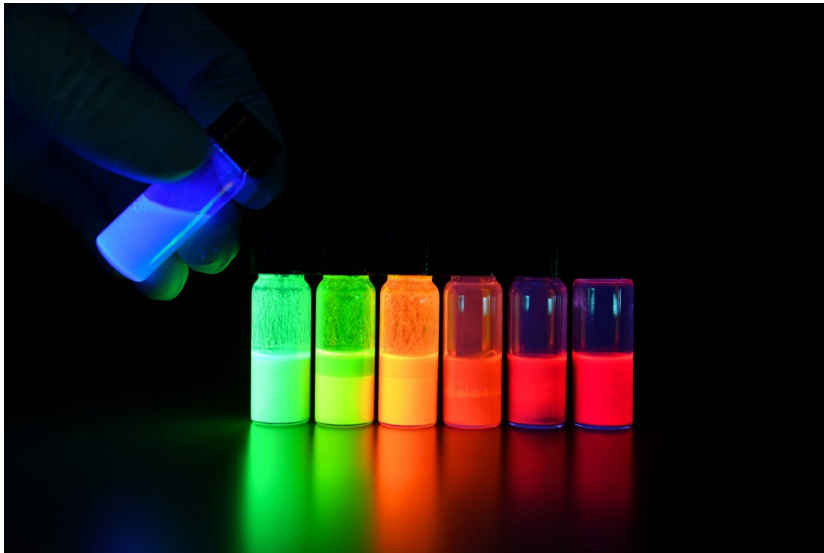
Σχήμα 3.8 - Νανοκρύσταλλοι CsPbBr_3 κατασκευασμένοι από τους Q. Chen et al. ώστε να εκπέμπουν ποικιλία χρωμάτων - χρησιμοποιήθηκαν ως επικάλυψη σε φωτοδιόδους ανιχνευτών ακτινών X . [70]
