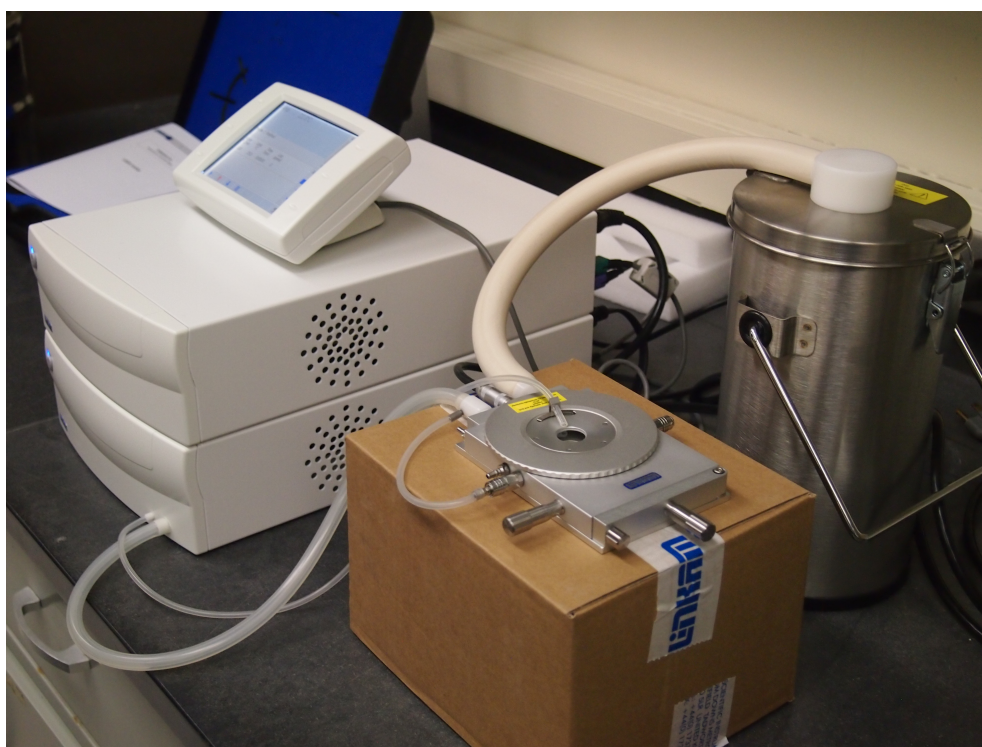
Σχήμα 4.1 – Linkam THMS600 Stage: Τυπική διάταξη δείγματος εντός αεροστεγούς κυψελίδας, συνδεδεμένη με σύστημα ψύξης-θέρμανσης με εύρος από -196^{\circ} μέχρι 600^{\circ}C . Η ψύξη πραγματοποιείται με τη χρήση υγρού αζώτου. [72]
