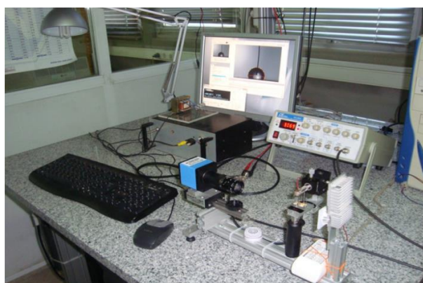
Σχήμα 5.22 Πειραματική διάταξη μετρήσεων γωνίας επαφής
