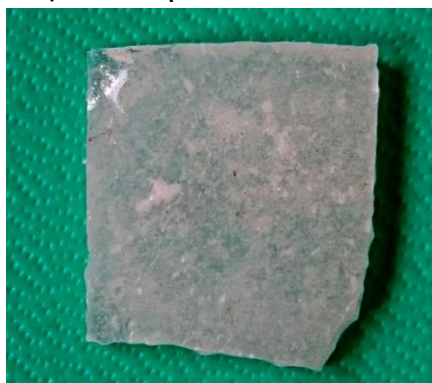
Σχήμα 5.5 Δείγμα 90/10 PDLLA MG /PEG 10,000 κατασκευασμένο με τεχνική τήγματος
