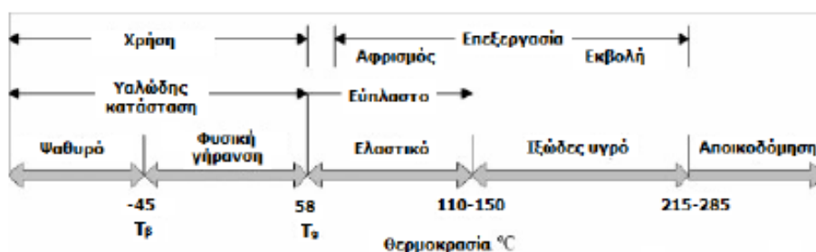
Σχήμα 1.6 Μετασταθείς καταστάσεις υψηλού μοριακού βάρους άμορφου PLA
