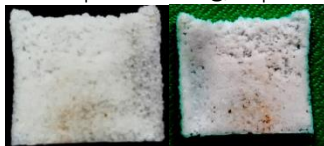
Σχήμα 7.14 Φωτογραφίες των ικριωμάτων πριν και μετά την εμβάπτισή τους στο ρυθμιστικό διάλυμα με pH 7.4
