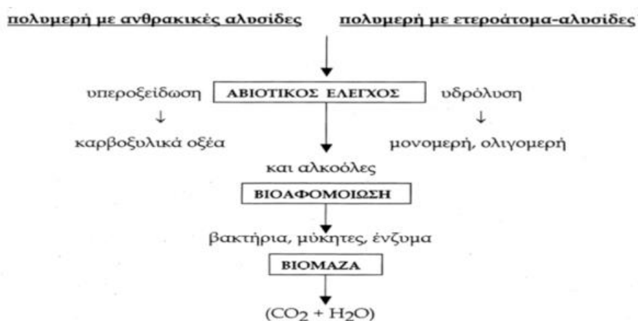
Σχήμα 3.1 Βιοδιάσπαση πολυμερών μέσω φυσικοχημικών διεργασιών
