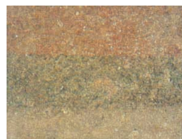
Διακοσμητικό επίχρισμα δεύτερης οικοδομικής φάσης, στο εσωτερικό του κτηρίου, (FOMx30)
