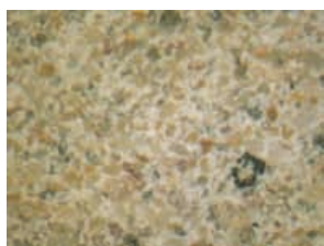
Φινίρισμα επιχρίσματος (FOM, x50), εξωτερική τοιχοποιία κτηρίου
