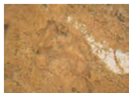
Ασβεστοπηλοκονίαμα (FOM, x50), εμφανές το χαρακτηριστικό συσσωμάτωμα ασβέστη, εξωτερική τοιχοποιία κτηρίου
