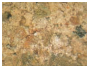
Υπόστρωμα επιχρίσματος (FOM, x50), εξωτερική τοιχοποιία κτηρίου
