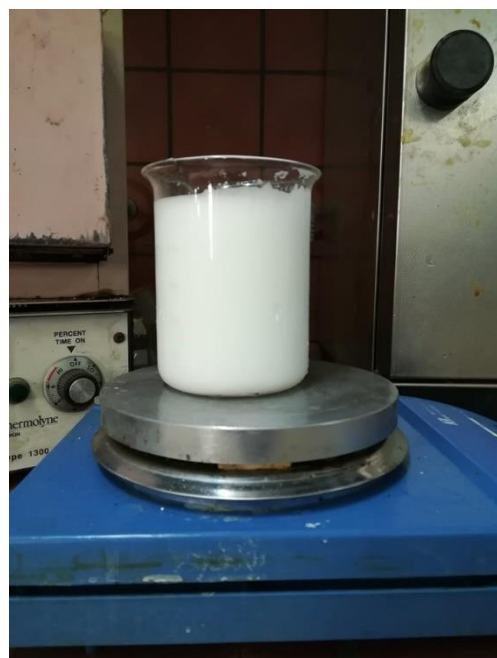
Σχήμα 2.2. α) Πειραματική διάταξη παραγωγής μικροκαψουλών, β) Μαγνητική ανάδευση διπλού γαλακτώματος για εξάτμιση διαλύτη
