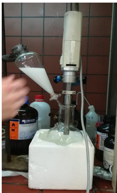
Σχήμα 2.2. α) Πειραματική διάταξη παραγωγής μικροκαψουλών, β) Μαγνητική ανάδευση διπλού γαλακτώματος για εξάτμιση διαλύτη
