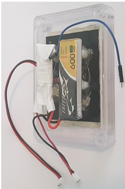
Εικόνα 8.3: Συνδεσμολογία 2 η : συσσωρευτής – διαίρετης τάσης – ΦΒ στοιχείο – καπάκι (αριστερά: εσωτερική όψη, δεξιά: εξωτερική όψη)
