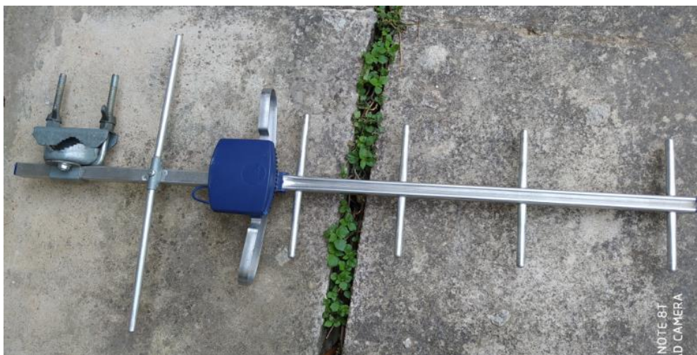
Σχ.5.8 Η κεραία εκπομπής με κέρδος 6db
