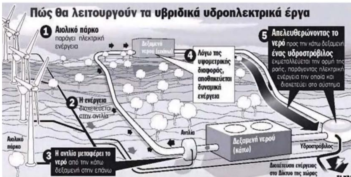
Σχήμα 2.2 Απεικόνιση Υβριδικού Συστήματος με Α/Γ και Υδροηλεκτρικά έργα (Πηγή: https://www.tanea.gr/ )
