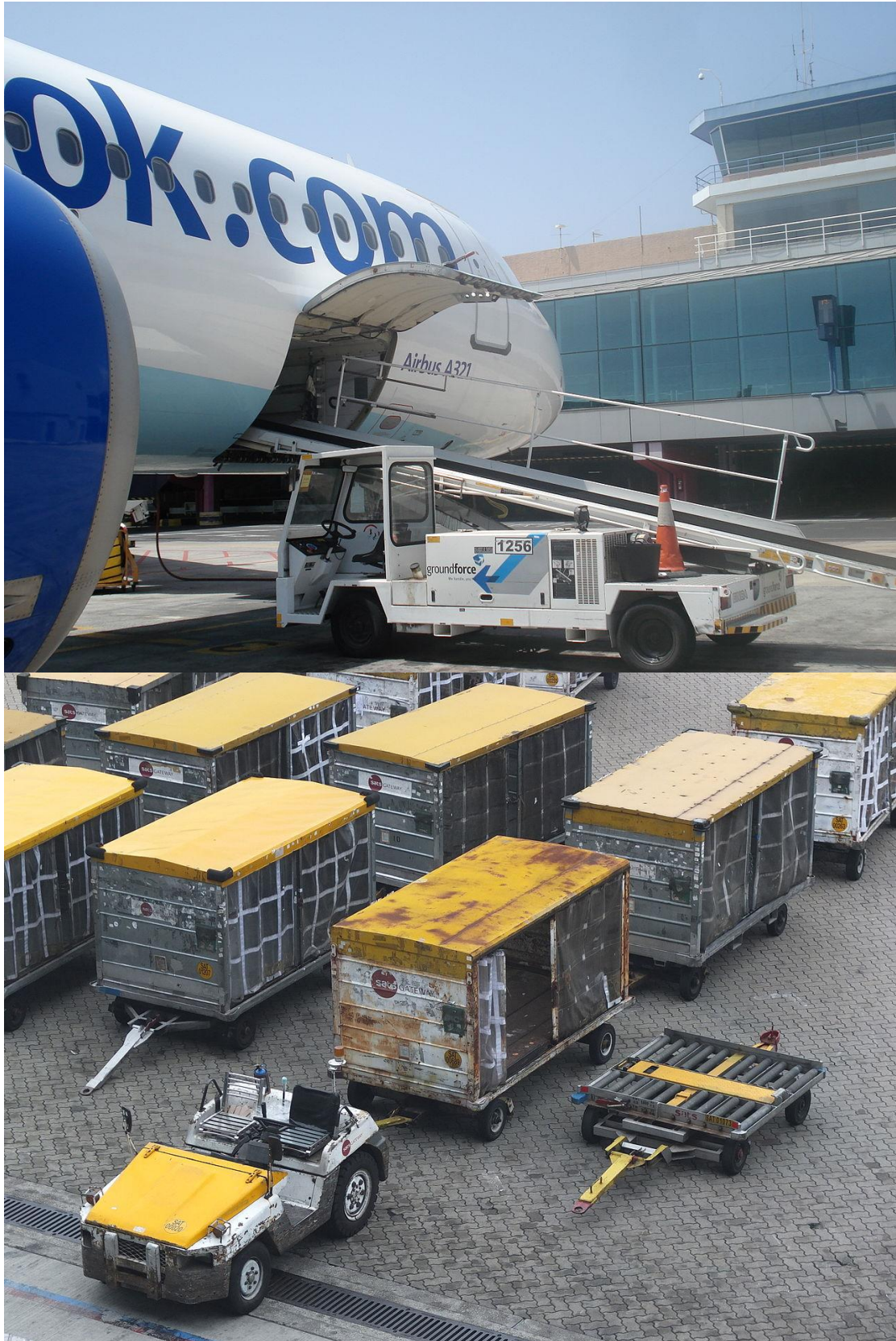
Εικόνα 3.7: Φορτωτής με πλάστιγγες (πάνω), τράκτορας με διάφορα είδη αμαξιδίων μεταφοράς αποσκευών και μεταφορικών μονάδων φορτίου
