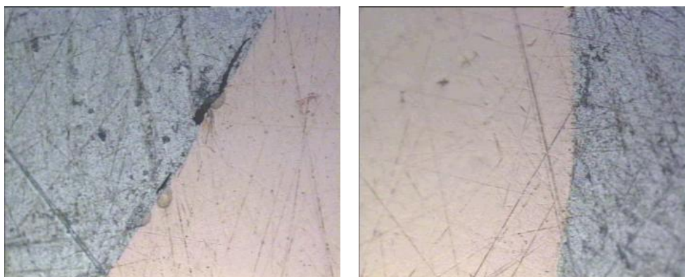
(Αριστερά) Ρηγματώσεις, πόροι και διακενώσεις – 50X
