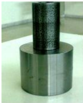
Τμήμα εισόδου, τμήμα εξόδου και κωνικό τμήμα (όχι άμεσα ορατό) της μήτρας
