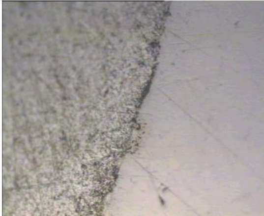
(Αριστερά) Ρηγματώση – 50X
