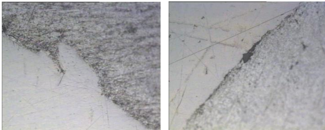
(Αριστερά) Εισχώρηση χαλύβα – 50X
