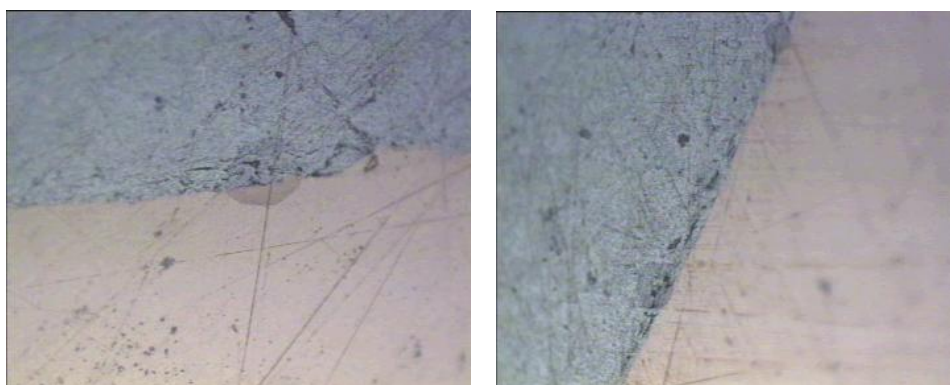
(Αριστερά) Εισχώρηση και πόρος – 50X
