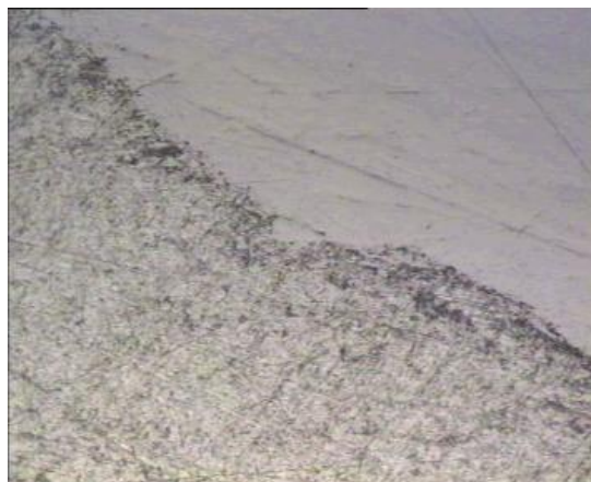
(Αριστερά) Εισχώρηση χάλυβα – 50X
