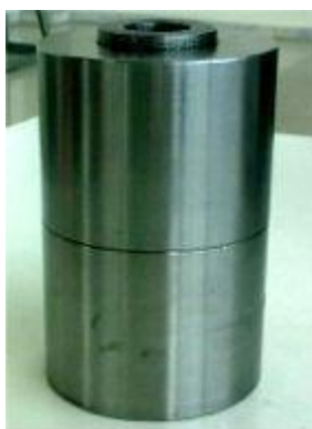
Συναρμολογημένο σύνολο των τεσσάρων πρώτων τμημάτων της μήτρας
