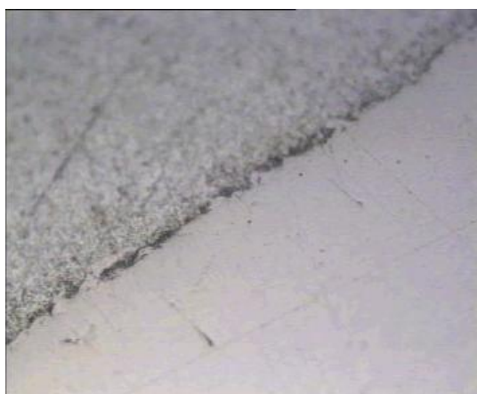
(Αριστερά) Ρηγματώση – 50X
