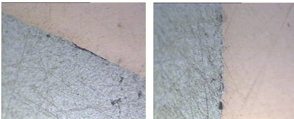
(Αριστερά) Ρηγματώση – 50X
