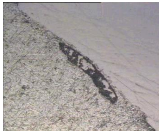
(Αριστερά) Εισχώρηση χάλυβα – 50X
