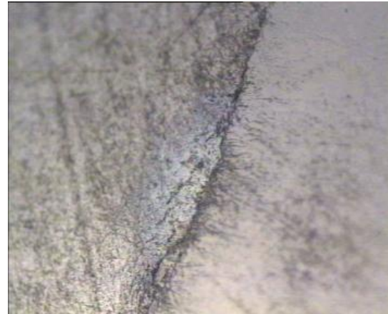
(Αριστερά) Ρηγματώση – 50X
