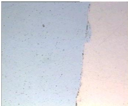
(Αριστερά) Εισχώρηση χάλυβα στο χαλκό και γραμμικό πορώδες πάνω στη διεπιφάνεια – 20X
