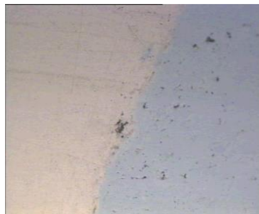
(Αριστερά) Εισχώρηση χάλυβα στο χαλκό και γραμμικό πορώδες πάνω στη διεπιφάνεια – 20X
