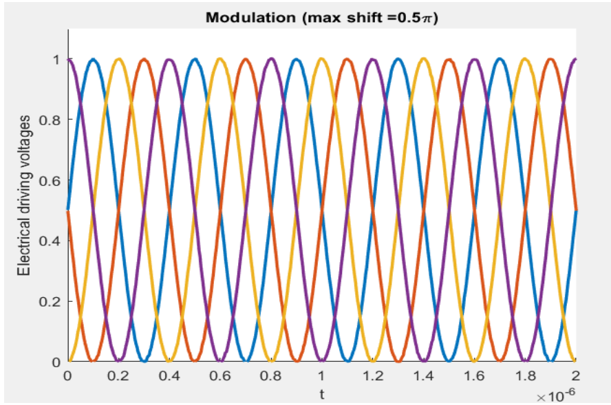
Εικόνα 3.7 Ιδανικά ημιτονοειδή ηλεκτρικά σήματα οδήγησης του Four-Branch Shifter
