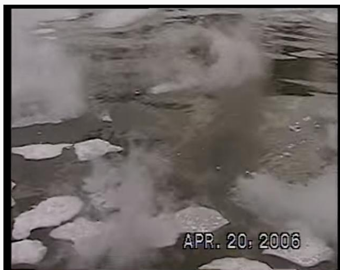
Εικόνα 9: Σύννεφο ατμού LNG σε νερό [30]
