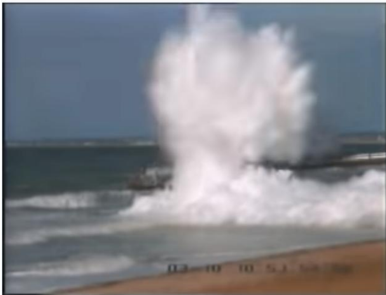
Εικόνα 51: Απότομη μετάβαση φάσης LNG [40]
