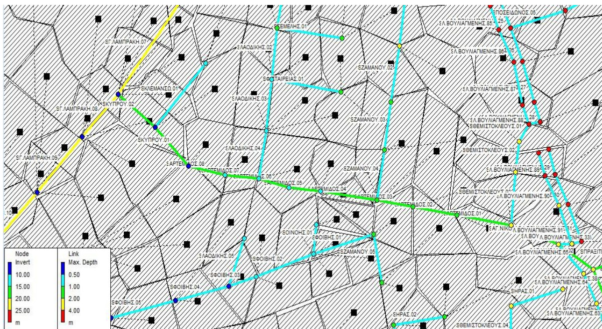
Σχήμα 5.44: Σχηματική αναπαράσταση των αγωγών των οδών Αρτέμιδος και Κύπρου στο νότιο τμήμα της περιοχής μελέτης.
