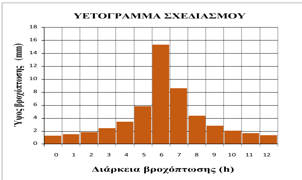
Σχήμα 2.1: Τυπικό υετόγραμμα σχεδιασμού κατασκευασμένο με την μέθοδο των εναλλασσόμενων μπλοκ.
