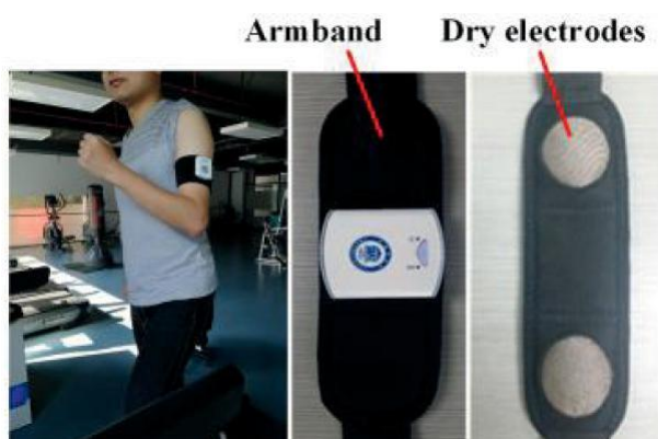
Σχήμα 29: Το περιβραχιόνιο με τα υφασμάτινα ηλεκτρόδια για την λήψη του ΗΚΓ [19]
