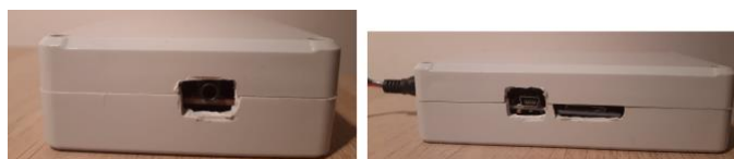
Σχήμα 60: Οι υποδοχές για το καλώδιο των τριών ηλεκτροδίων, του καλωδίου USB του Arduino Nano και της κάρτας micro sd
