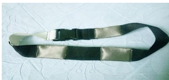
Σχήμα 37: Η ζώνη με τα ηλεκτρόδια από αγώγιμο ύφασμα [20]
